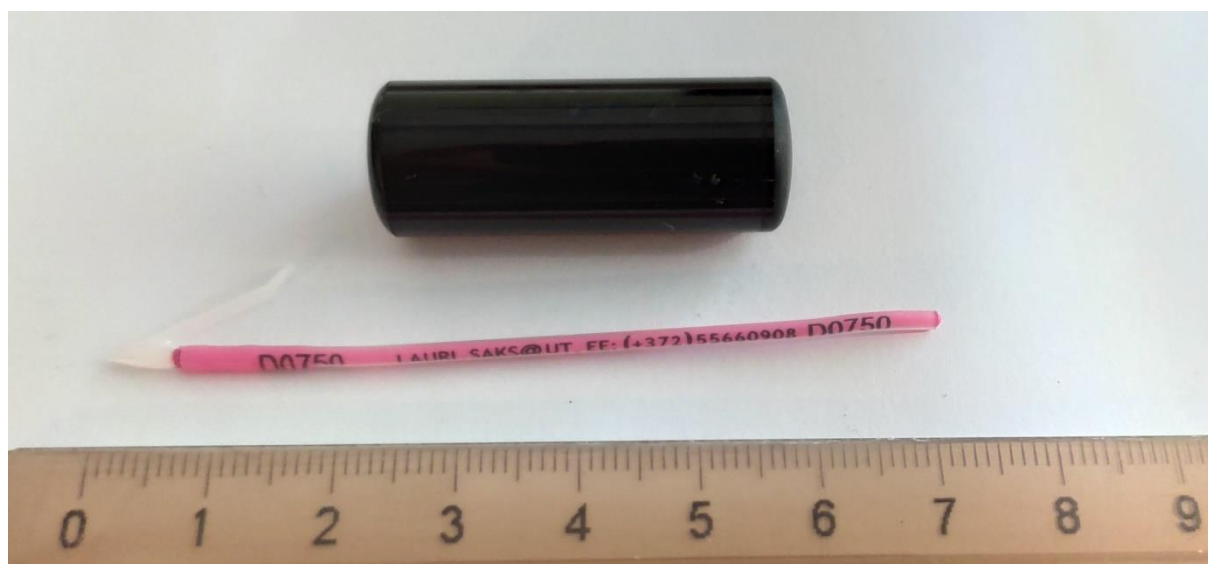
Foto 3. Uuringus kasutatud märgised. Üleval kehasisene hüdroadustiline märgis ning all dart-tag tüüpi kehavälise ankurmärgis.
