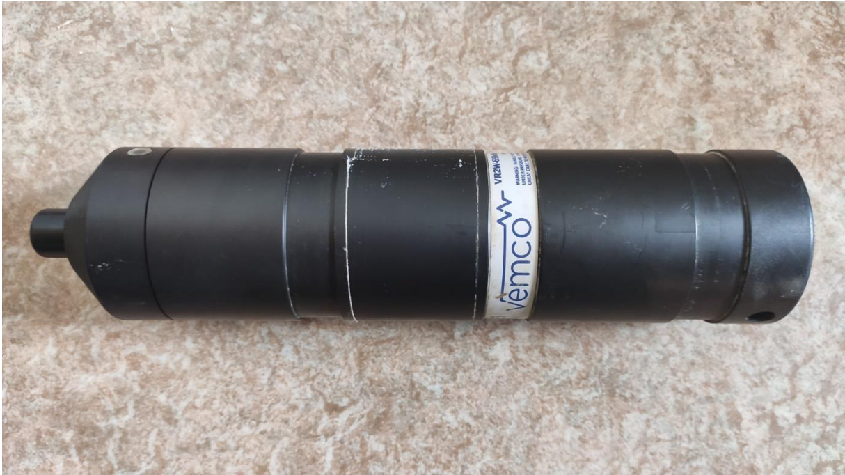
Foto 5. Uuringus kasutati VEMCO poolt toodetud VR2W-69kHz hüdrofone.
