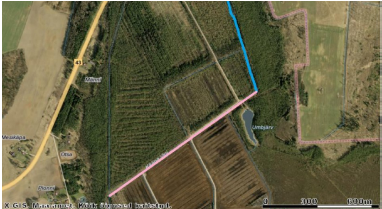
Joonis 1. Kääpa jõe (VEE1053700) uus ruumikuju Keressaare turbatootmisala piirkonnas. Roosa värviga on märgitud Kääpa jõe küljest eraldatav kuivenduskraav. Sinise joonega on märgitud Kääpa jõe voolusäng.
