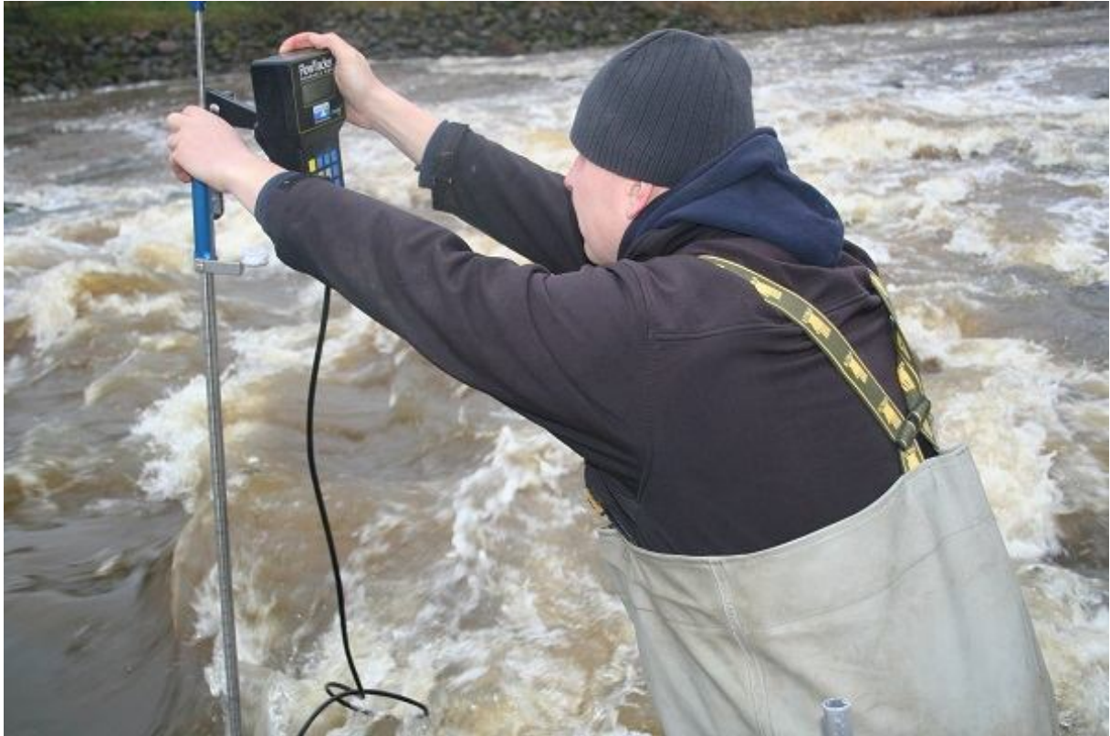
Foto 1.2.17.10. Vee voolukiiruste mõõtmine Laastre paisul 03.12.2015 (M. Sepp).
