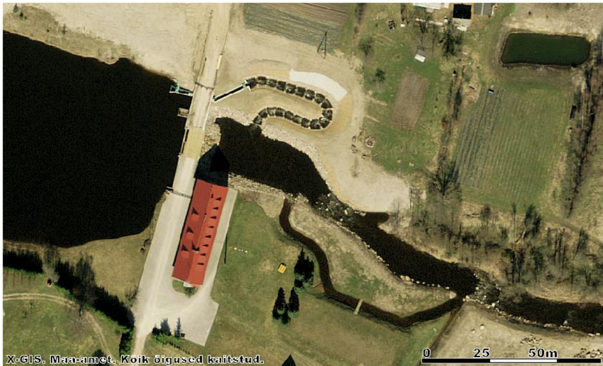
Joonis 1.2.8.3. Koseveski kalapääs asub jõe vasakul kaldal ja on oma tüübilt tiikide kaskaadi ja pilupääsu kombinatsioon. Kalapääsu alavee poolne pikem osa on loodusilmeliste tiikide kaskaad, ülavee poolne osa koosneb 0-languga betoonkanalist (vahetult tee tammist allavoolu jääv osa) ja pilupääsu kambritest (tee tammi all ja sellest ülesvoolu jääv osa).
