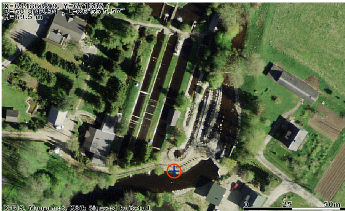
Joonis 1.2.2.3. Karilatsi kalapääs on hajuskärestiku tüüpi möödaviik-pääs. Kalapääs asub jõe vasakul kaldal. Kalapääsu sissevool on joonisel tähistatud punase ringiga. Kalapääsust vasakule jäävad Karilatsi kalamajandi kalakasvatustiigid.
