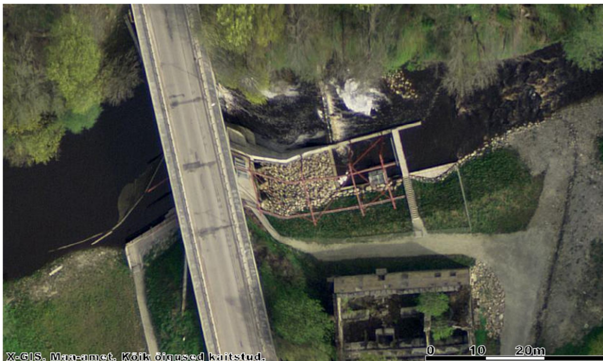
Joonis 1.2.7.3. IMG Energy kalalift asub jõe parema kalda ääres. Lifti teekonda markeerib punane metallist tõstekonstruksioon, lifti puur on näha tõstekonstruksiooni alaveepoolses otsas (halli värvi).
