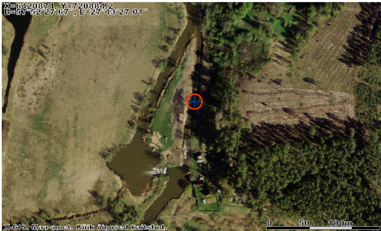
Joonis 1.2.15.3. Tsüdsina kalapääs (punane ring) otrofotol. Tüübilt on kalapääs tiikide kaskaad. Kalapääsu pikkus on 160 m. Kalapääsu väljavoolu kaugus liigveelasust on jõe pidi 200 m.
