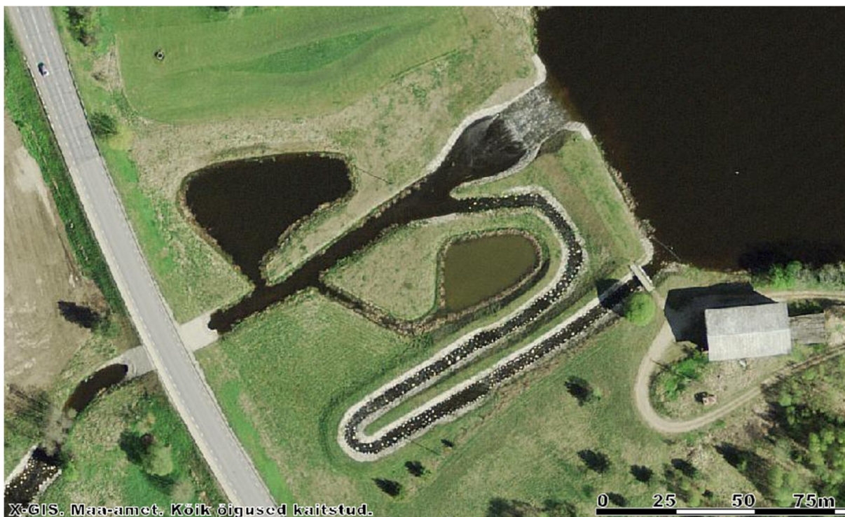
Joonis 1.2.1.a.3. Külajärve kalapääs on hajuskärestiku tüüpi möödaviik-pääs. Kalapääs on rajatud liigveelasust vasakule.
