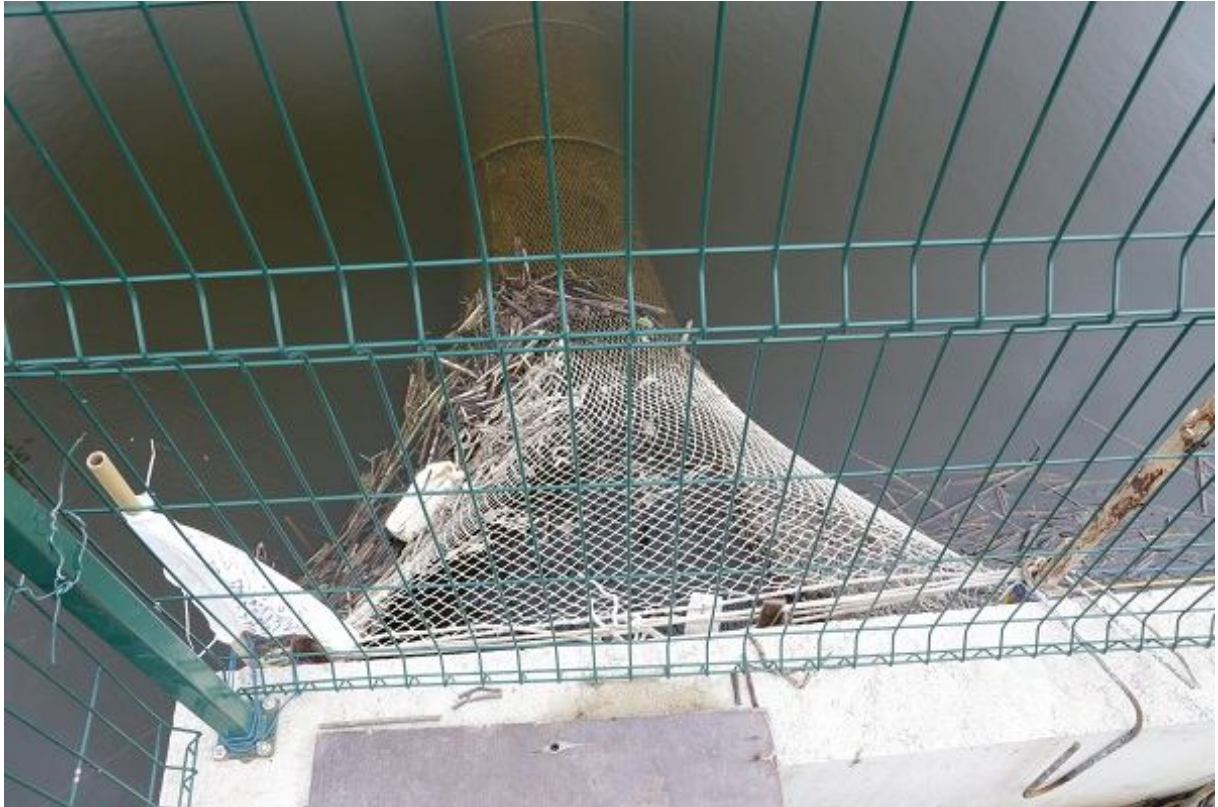
Foto 1.2.14.15. Kevadseire ajal 20.04.-25.06.2015 oli kalapääsu sissevool mõrraga suletud. Kokku saadi mõrrast 17 ahvenat ja 1 haug, enamik kaladest pärast HEJ pideva töörežiimi lõppu 08.06.2015. Paisu all ja pääsul märgistatud 57-st suuremast kalast (20 haugi, 30 turba, 3 särge, 2 linaskit, 1 ahven) jõudis mõrda ainsana 1 ahven (19.05.2015, R. Järvekülg).
