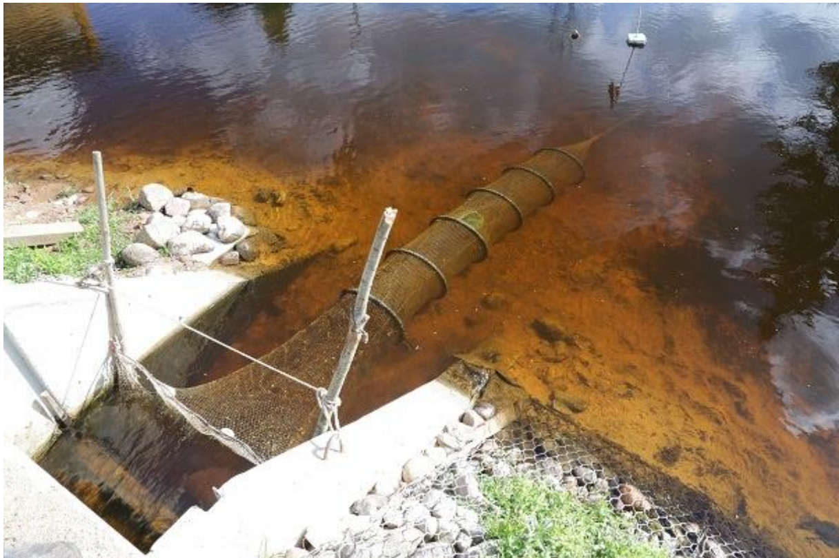
Foto 1.2.2.9. Kalade rännet Karilatsi kalapääsul seirati kevad perioodil 21.04.-04.06.2015, kokku 44 päeva jooksul. Kalapääsu sissevool oli suletud mõrraga, kokku registreeriti mõrras 6 kalaliiki ja 2246 isendit (08.05.2015, R. Järvekülg).
