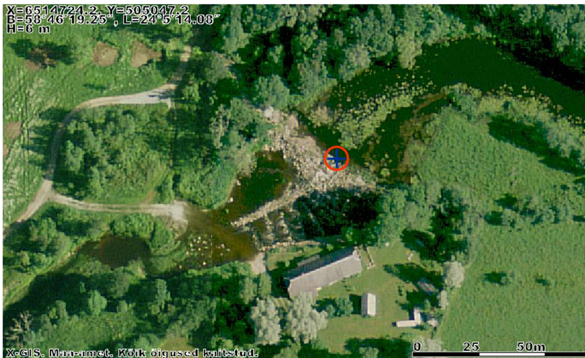
Joonis 1.2.17.3. Laastre kalapääs ortofotol. Kalapääsu sissevool on näidatud punase ringiga. Kalapääs algab ülavee poolt paisu keskelt ja suundub siis tiikide kaskaadina jõe vasakusse serva ning edasi kallast pidi allavoolu.
