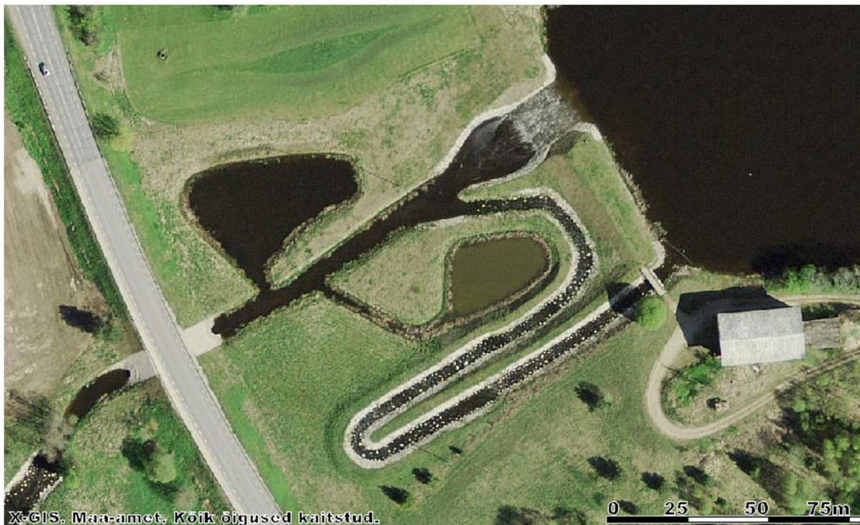
Joonis 1.2.1.a.3. Kälajärve kalapääs on hajuskärestiku tüüpi möödaviik-pääs. Kalapääs on rajatud liigveelasust vasakule.
