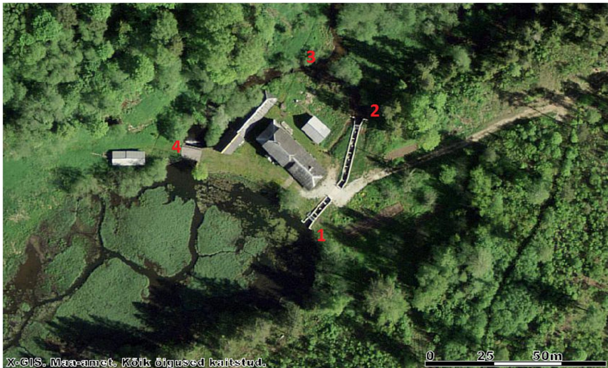
Joonis 1.2.3.3. Roti kalapääs on oma tüübilt kamberkalapääs. Kalapääsu sissevool asub paisjärve kirdenurgas. Paisjärv on setteid täis kandunud ning taimestikku ohtralt täiskasvanud. 1- kalapääsu sissevool, 2- kalapääsu väljavool, 3- kalapääsu väljavooluharu suubumiskoht jõkke, 4- liigveelask.
