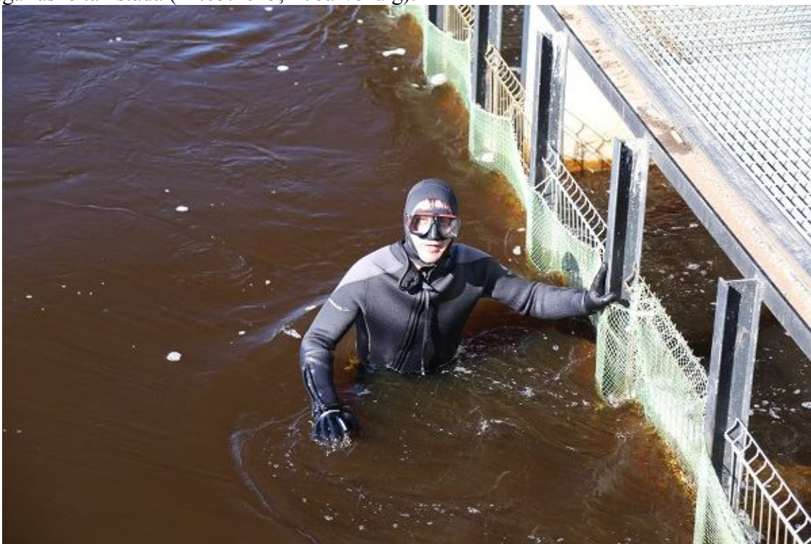
Foto 1.2.13.10. HEJ väljavoolukanali võre sobis väga hästi mõrra küljelina kinnitamiseks. Nii oli kalade laskuva rände uuringuks 10 m laiune kanal võimalik mõrraga efektiivselt sulgeda. Kuna HEJ turbiine läbinud kaladest sai osa surma ning kandus veega piki äravoolukanalit mõrralinani, aga mõrda loomulikult ei läinud, siis tuli seireperioodil igal hommikul mõrra lina ümbrus akvalangiga sukeldudes läbi uurida (16.05.2015, M. Sepp).
