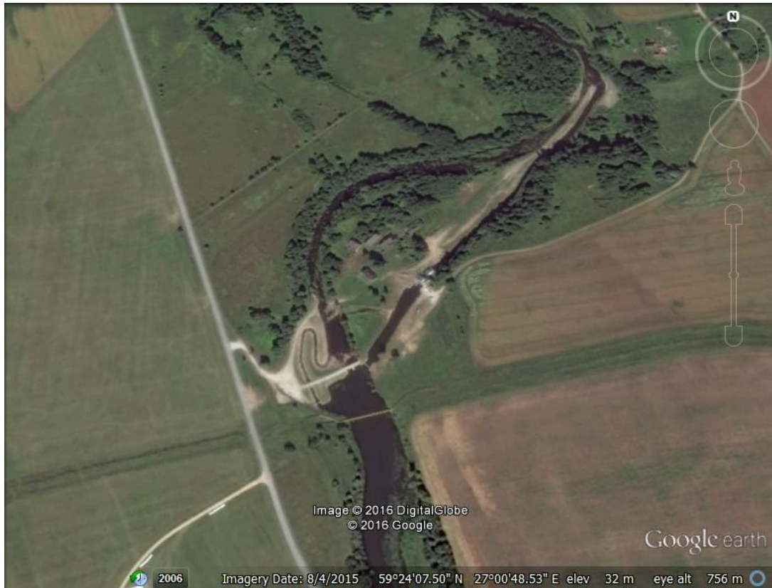
Joonis 1.2.13.3. Sillaoru kalapääs asub jõe vasakul kaldal. Paisu paremast servast algab Sillaoru hüdroelektrijaama derivatsioonikanal, mille pikkus on 500 m (130 m pikkune juurdevoolukanal ning ca 370 m pikkune äravoolukanal).
