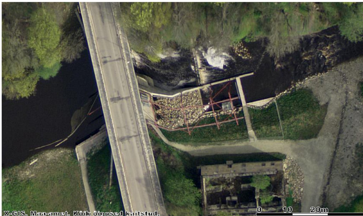
Joonis 1.2.7.3. IMG Energy kalalift asub jõe parema kalda ääres. Lifti teekonda markerib punane metallist tõstekonstruksioon, lifti puur on näha tõstekonstruksiooni alaveepoolses otsas (halli värvi).
