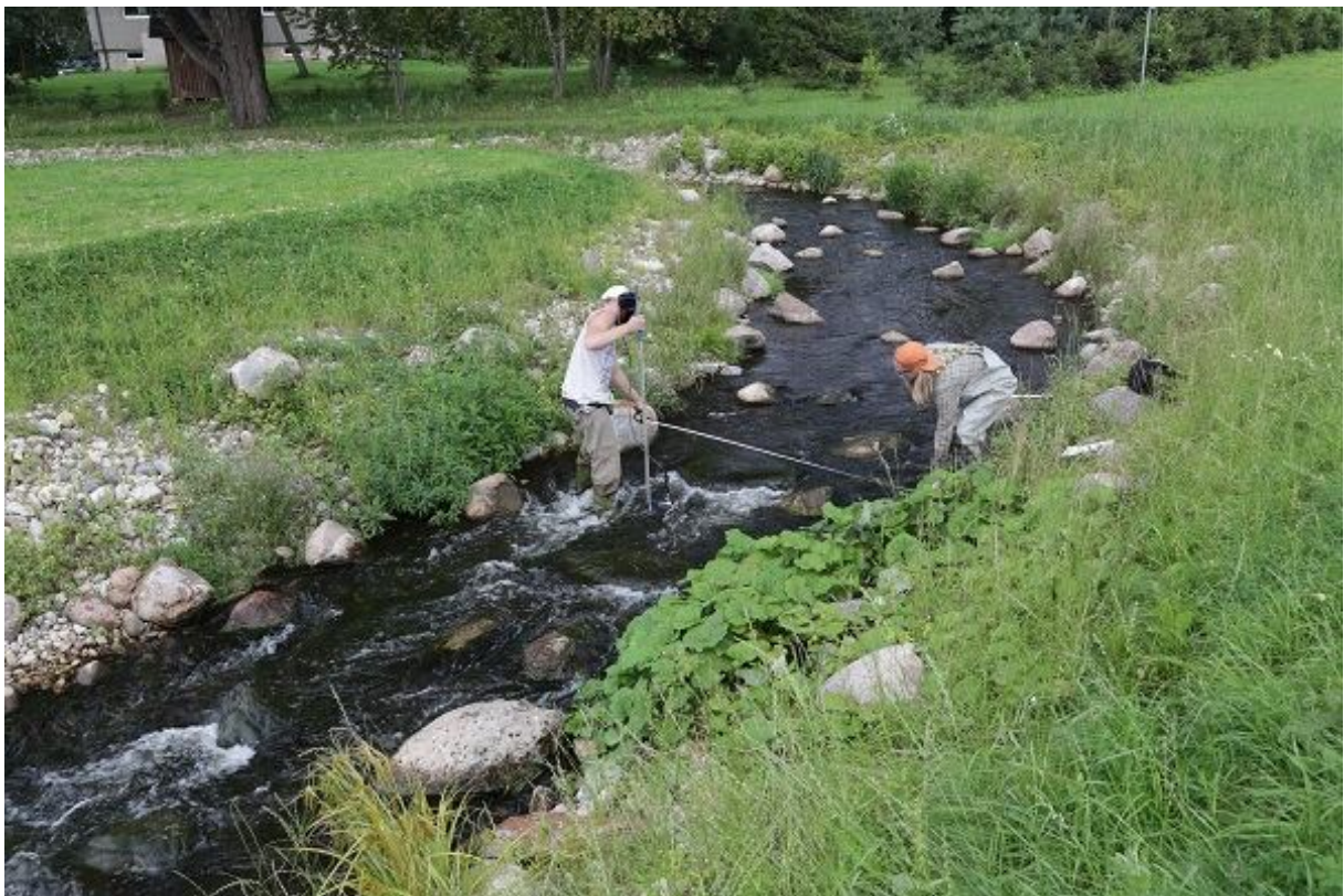
Foto 1.2.1.b.3. Veskijärve kalapääsu keskosa. Hüdrauliliste tingimuste kirjeldamine kalapääsul sisaldas voolukiiruste mõõtmist kiirevoolulistes kohtades (10.07.2014, R. Järvekülg).
