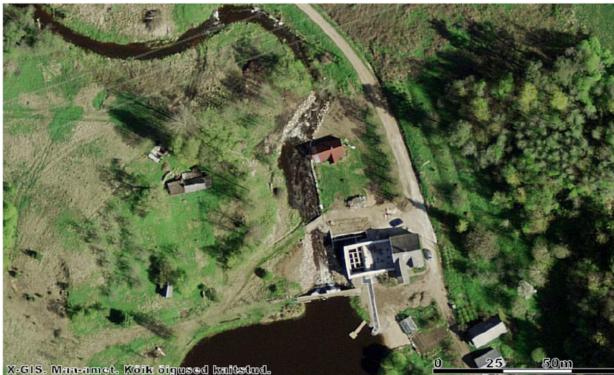
Joonis 1.2.12.3. Sasi kalapääs on rajatud jõe paremale kaldale, tüübilt on tegemist kamberkalapääsuga. Osa kalapääsust asub vana veskihoone sees (katus puudub).
