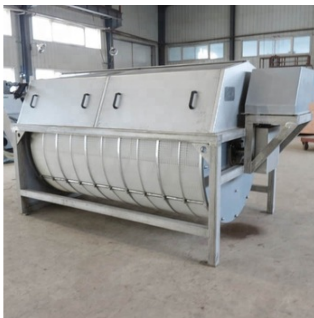
Joonis 3. Trummelfiltri puhastusefektiivsus oleneb pooride suurusest.
