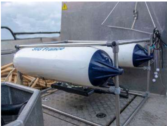
Joonis 15. Madalasagedusliku Boomer -tüüpi setteprofiilaatori pukseeritav katamaraan ja selle alla kinnitatud metallplaatidest seisreaktiivse signaali tekitav kiirgur-saatja (vasakul) ning süsteemi kontrollseade (paremal).
