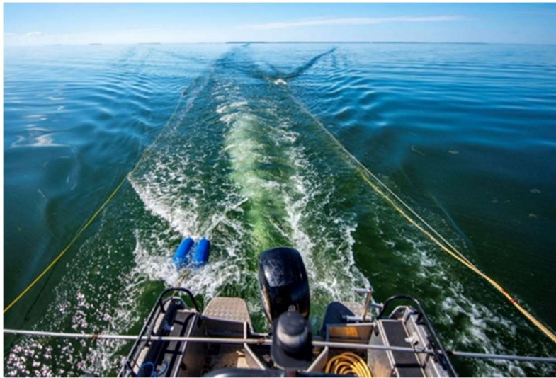
Joonis 8. Kõrgesageduslik kajalood ( Pinger ) pukseerituna siniste poide külge kinnitatuna (uurimispaa di ahtrist vasakul). Madalsageduslik setteprofiilaator ( Boomer ) (valged poid taamal paremal) ja selle vastuvõtja hüdrofon (vasakul) 20 meetri kaugusel ahtrist.
