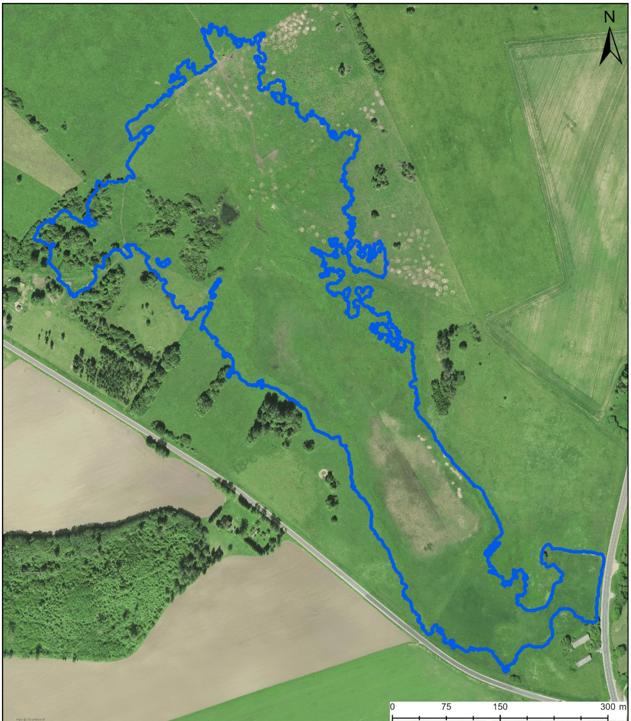
Joonis 4.2.5. Assamalla karstijärviku veepiir tasemel 113,5 m ü.m.p vastavalt Maa- ja Ruumiameti 2020. aasta metsandusliku lennu käigus kogutud LiDAR-andmete alusel loodud 1x1 m kõrgusmodelile.
