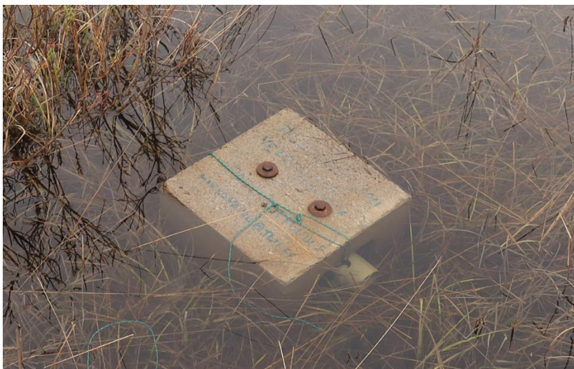
Joonis 3.1. Kergkruusaploki külge kinnitatud veetaseme- ja elektrijuhtivuse andur. Pilt: Marko Vainu.
