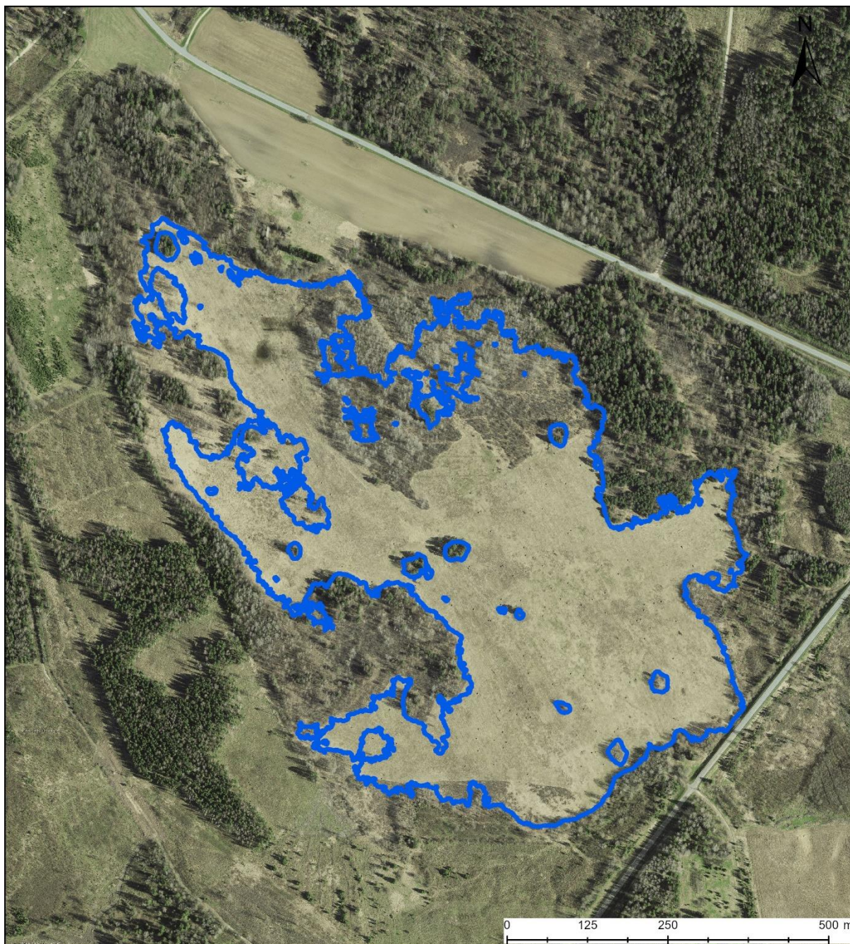
Joonis 4.3.6. Einjärve karstijärviku veepiir tasemel 111,4 m ü.m.p vastavalt Maa- ja Ruumiameti 2018. aasta kevadise lennu käigus kogutud LiDAR-andmete alusel loodud 1x1 m kõrgusmudelile.
