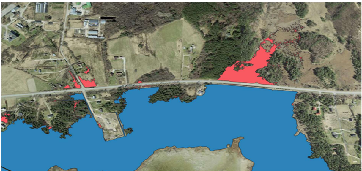
Joonis 3. Näidis Kuressaare riskipiirkonnast, kus sinisega on näidatud omavahel seotud olnud ala ning punasega mittedisidus ala, mis eemaldati hilisemast andmetöötlusest. Eeldatud on, et vesi ei ulatu teisele poole teetammi.
