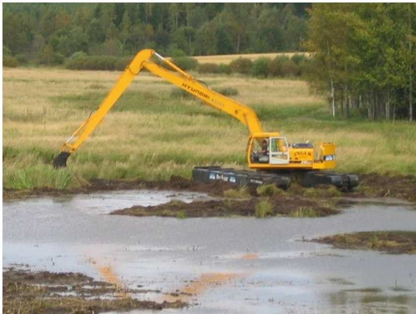
Joonis 5.7. Big float ujuvekskavaator töötamas õõtsikul (allikas: www.pme-equipment.org/index.php?page=big_float )
