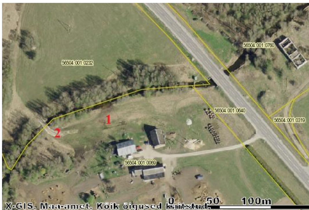
Foto 1. Ortofoto Maaameti X-GIS kaardirakendusest seisuga 28.04.2014. Lehmade jootmis- ja läbikäigu koht (1) ja jõe rajatud uus sild (2) Aadu talu maadel, vastavalt ca 100 ja 170 m Tallinna–Tartu mnt-st allavoolu, võisid olla setetekoormuse suurenemise põhjustajateks.
