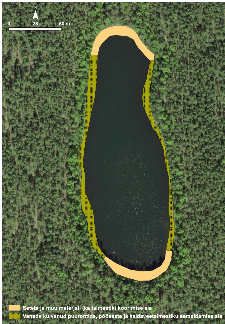
Joonis 24. Kuradijärve kaldatsoonist tuleb näidatud aladel eemaldada vanad kuivanud puurondid ja -tüved, pöösad ning kaldaveetaimestik. Näidatud on ka alad, kus on vaja eemaldada (nõ koorida) pindmine kuni 10 cm paksune settekiht koos seal olevate vanade puutüvede ja -rõntide ning taimestikuga.
