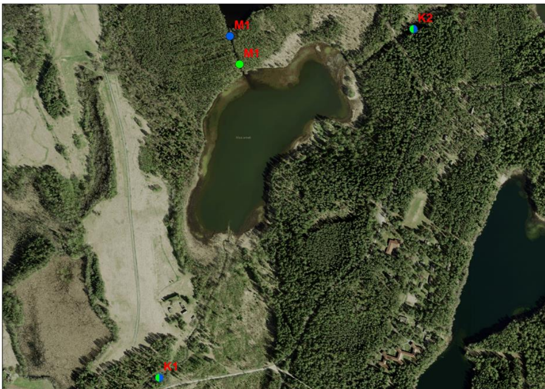
Joonis 3.1. Mõõtelävendid Raudi kanalil enne suubumist Nõmmejärve (K1), pärast väljavoolu Nõmmejärvest (K2) ning Mustjärve-Nõmmejärve kanalis vahetult enne suubumist Nõmmejärve (M1). Rohelise värviga on tähistatud vooluhulkade mõõtmise lävendid, sinise värviga veetaseme logerite asukohad.
