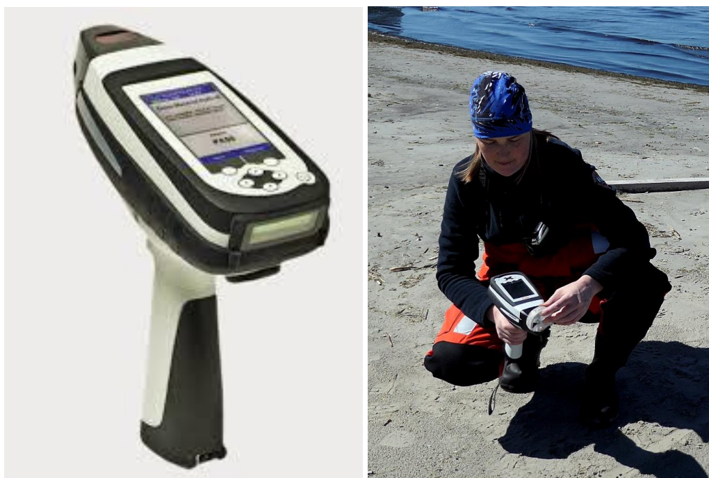
Joonis 4. Plastiku analüsaator MicroPHAZIR PC ja selle rakendamine välitöödel.
