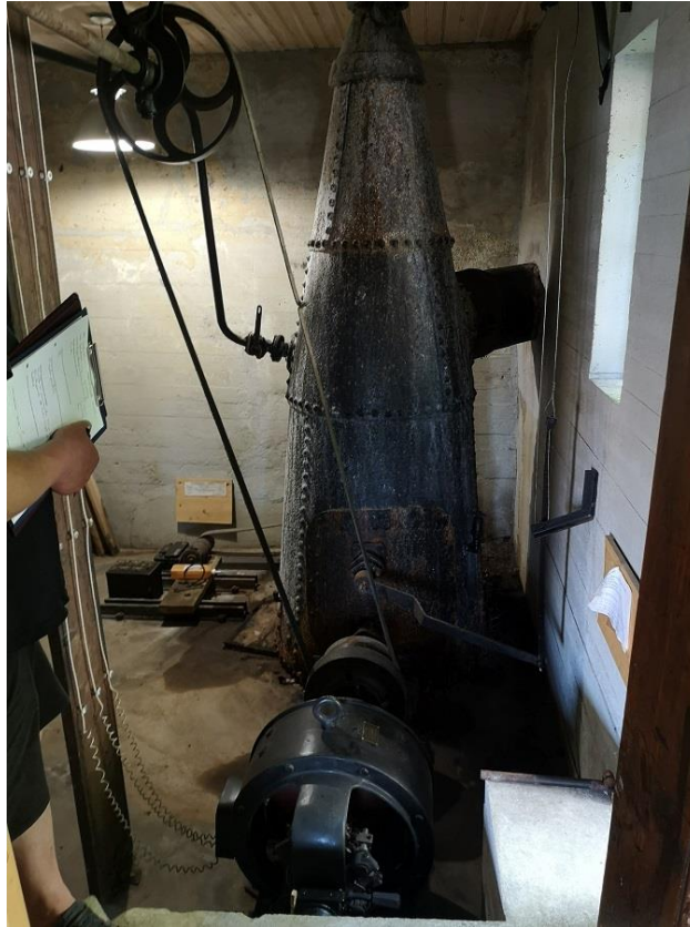
Foto Ööbikuoru 4. Veskihoones olev turbiin renoveeriti 2009-2010 aastal. Turbiin töötab ebaregulaarselt ja harva muuseumi eksponaadina (07.06.2022).
