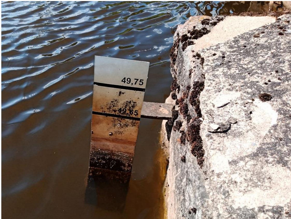
Foto Pikru 6. Paisjärves olev mõõtelatt näitab, et veetase on \leq 49,45 abs. Vastavalt veeloale peab paisjärve normaalpaisutustase olema 49,82 m abs \pm 5 cm. Sellest madalam veetase on lubatud ainult põua ajal, kui jõe vooluhulk ei kata paisu lekkeid. Vaatamata ligi 0,4 m NPT-st madalamale veetasemele hüdroelektrijaam töötab (13.06.2022)!
