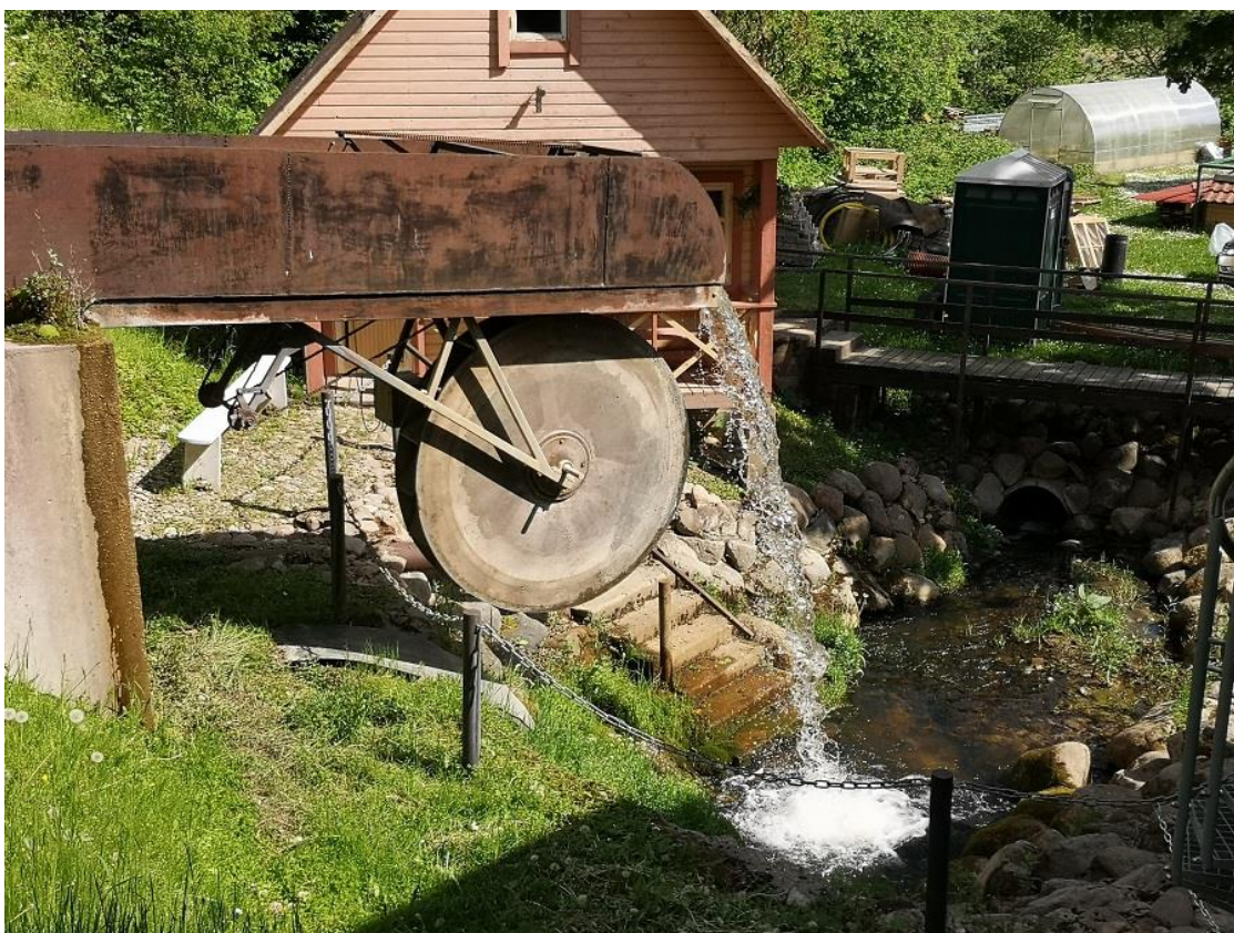
Foto Ööbikuoru 3. Paistiigist väljuva liigveelasu-kanali lõppu on ehitatud vesiratas, mis võimaldab hüdroenergia kasutamist (07.06.2022).
