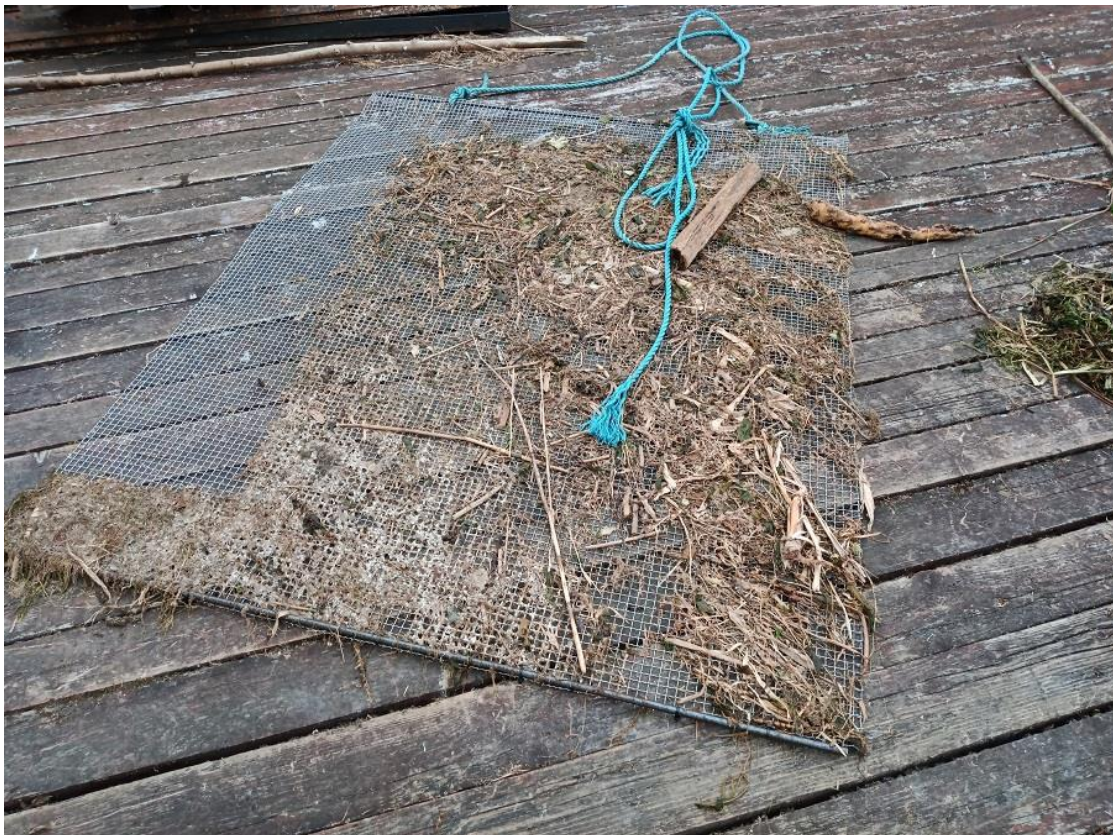
Foto Kamari 4. Kamari hej juures olnud tihedam võre (avad 10 x 10 mm), mida eeldatavasti kasutati põhivõre ees perioodil 20.04 kuni 10.06 (14.06.2022).
