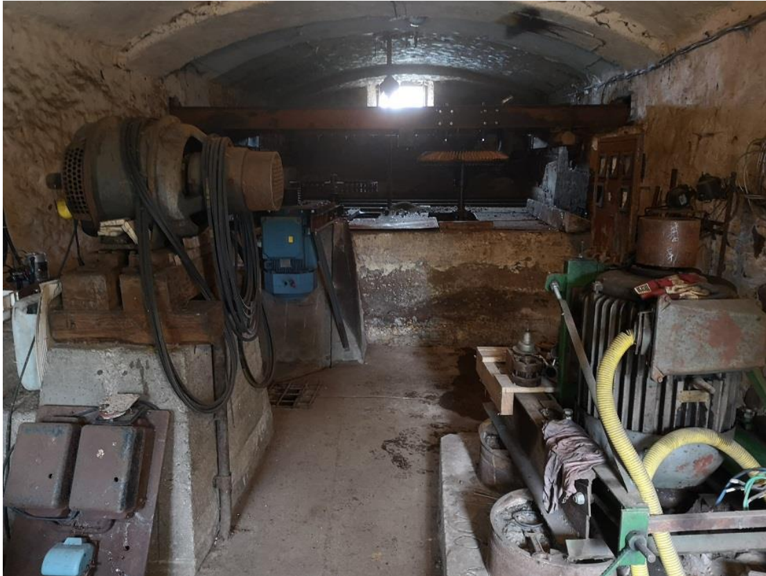
Foto Hellenurme 5. Hellenurme hej sisseseade. Jõu ülekandmiseks on kasutusel olnud erinevad rihmülekanded (26.08.2021).
