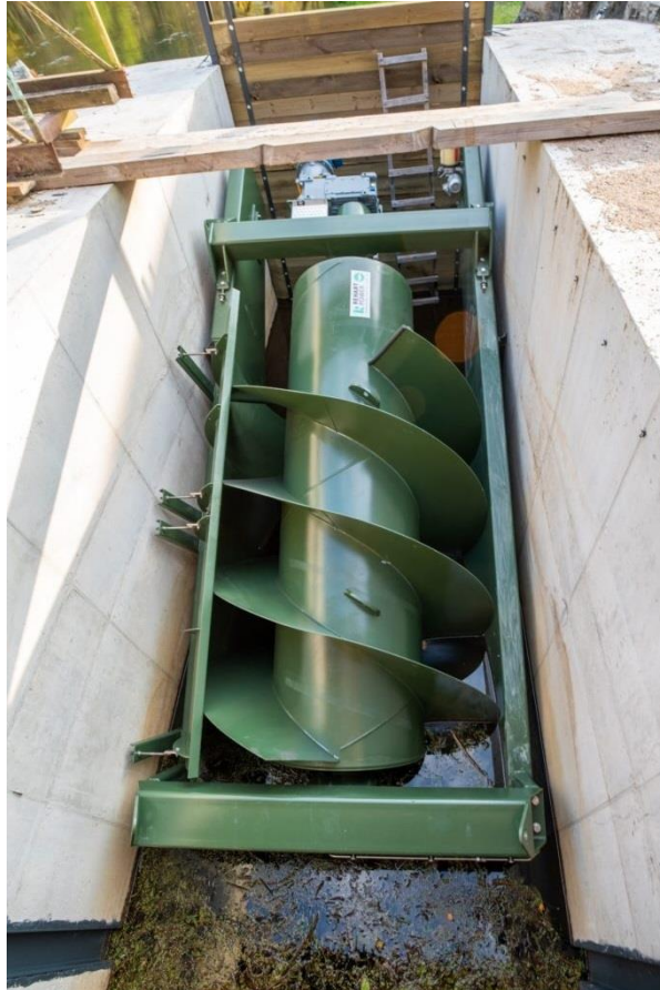
Foto Viira-3. Kruviturbiin paigaldati Viira veskisse 2021. a (foto IBUN OÜ).
