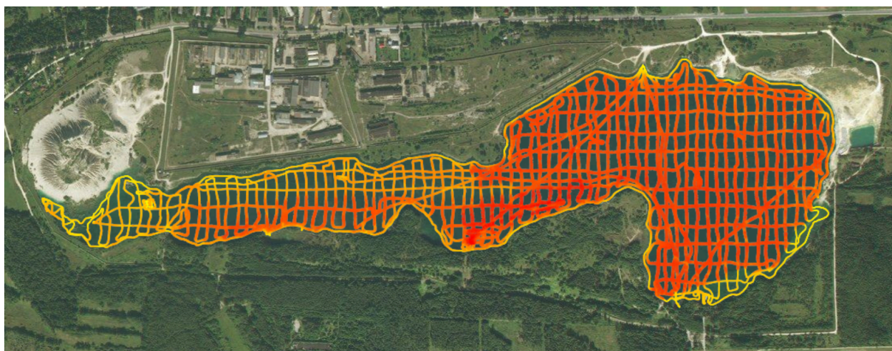
Joonis 3.11.1. Rummu järve sügavusmõõdistuste esialgsed töötlemata tulemused (värvi gradient madalast sügavasse: kollane-oranž-punane).
