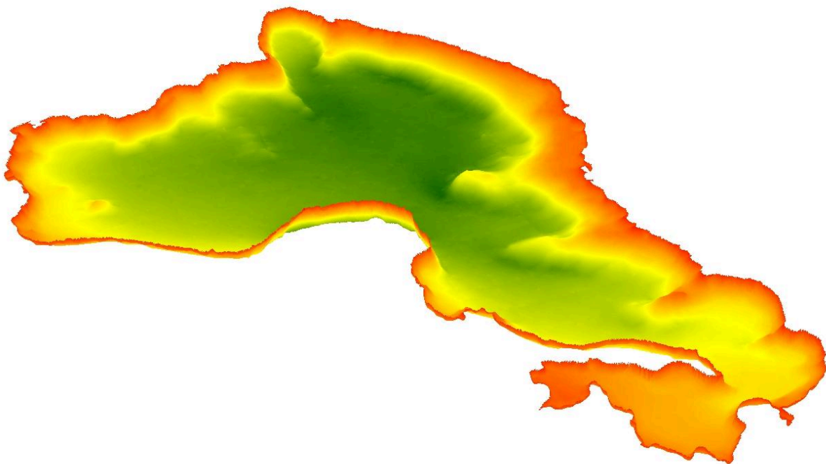
Joonis 3.1.3. Aheru järve 3D-mudel (värvi gradient madalast sügavasse: punane-oranž-kollane-heleroheline-tumeroheline).
