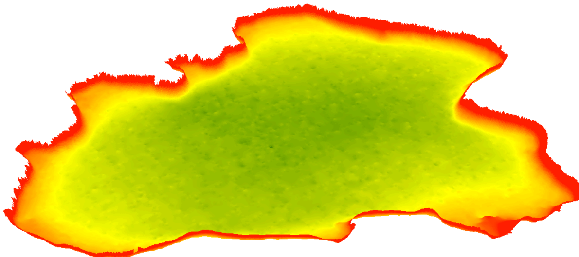
Joonis 3.3.3. Kaiu järve 3D-mudel (värvi gradient madalast sügavasse: punane-oranž-kollane-heleroheline-tumeroheline).
