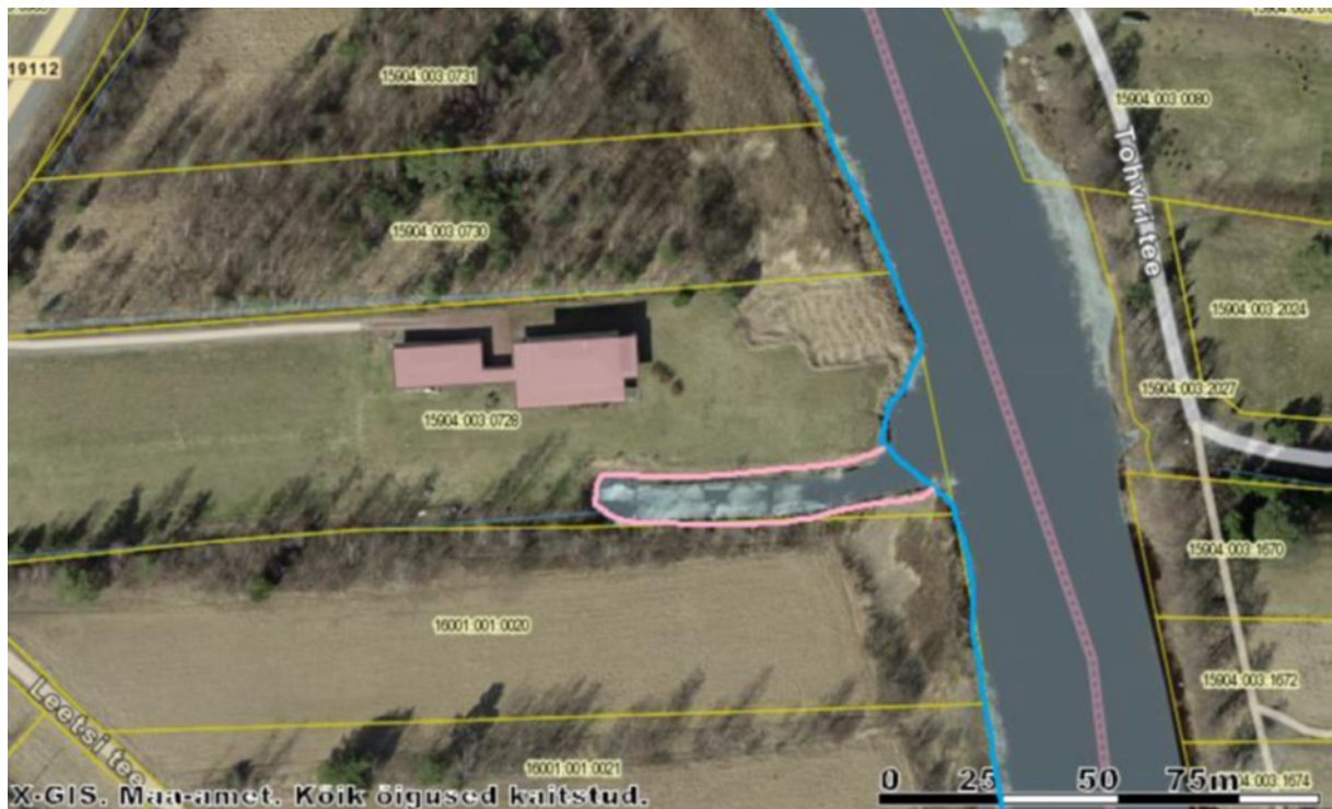
Joonis 1. Audru jõe (kaldajoon märgitud skeemil sinise joonega) küljest eraldatav ja eraldiseisva rajatisena keskkonnaregistrisse kantav Tammetalu paadikanal (märgitud skeemil roosa joonega)
