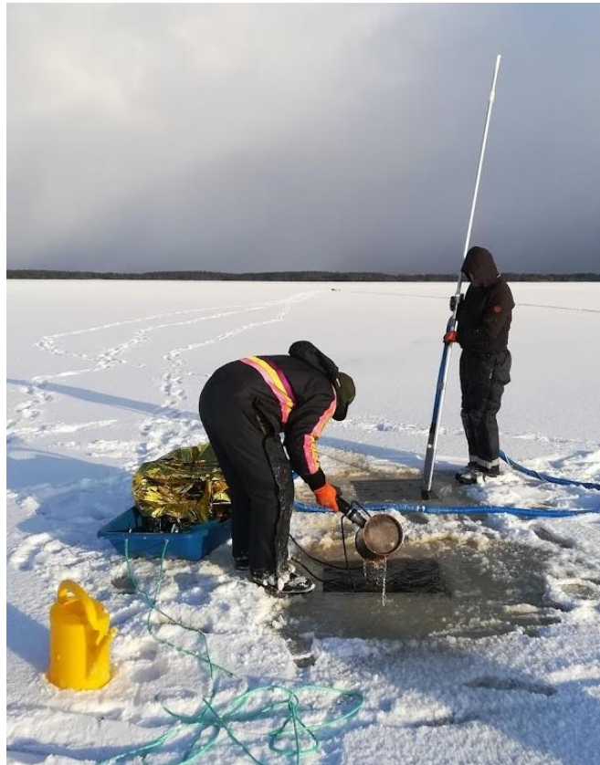
Joonis 1.1.15. Merisiia koelmualade inventeerimiseks kasutatud pumbasüsteemi kasutamine jäält proovi kogumiseks Soonlepa lahel (Foto Märt Kesküla, 21.01.2019).
