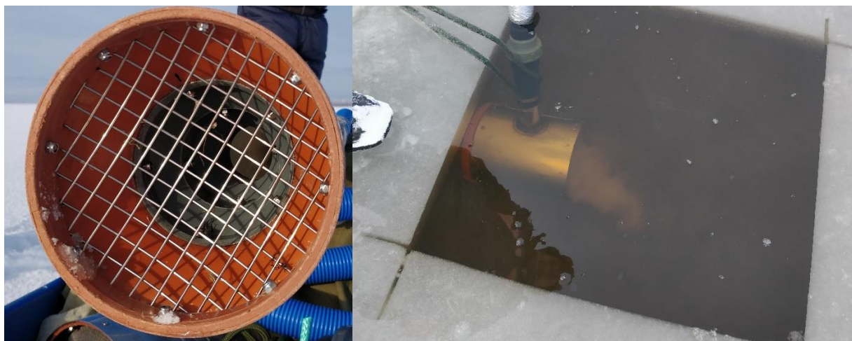
Joonis 1.1.14. Merisiia koelmualade inventeerimiseks kasutatud pumbasüsteemi sondi vee sissetõmbe ots (vasakul) ning vette sukeldatud, töötav proovi kogumiskamber (paremal) (Foto Lagle Matetski, 22.01.2019).
