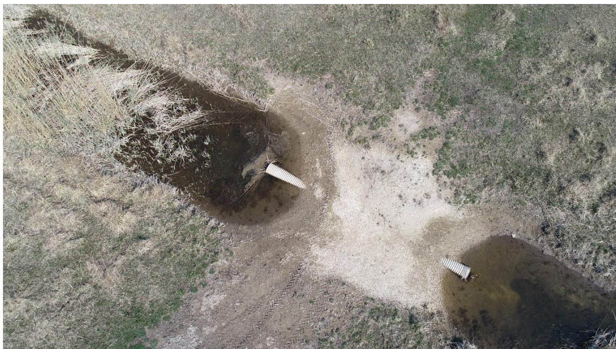
Joonis 3.74. Saardu peakraavi alamjooksul asuv peenike truup on potentsiaalne rändetakistus üle ujutatavast luhaalast ülesvoolu (Foto 24.04.2019).
