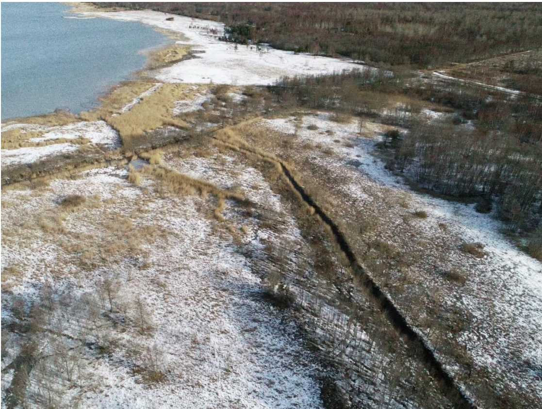
Joonis 1.1.3. Möldri merd Hara lahega ühendava kraavi suue on roostunud. Kaladele läbitava rändetee tagamiseks on vajalikud veekogu parendustööd sarnaselt Salajõe, Saunja lahe, Riimi mere ja Rannamõisa lahe süsteemis plaanitule (Foto 23.03.2020).
