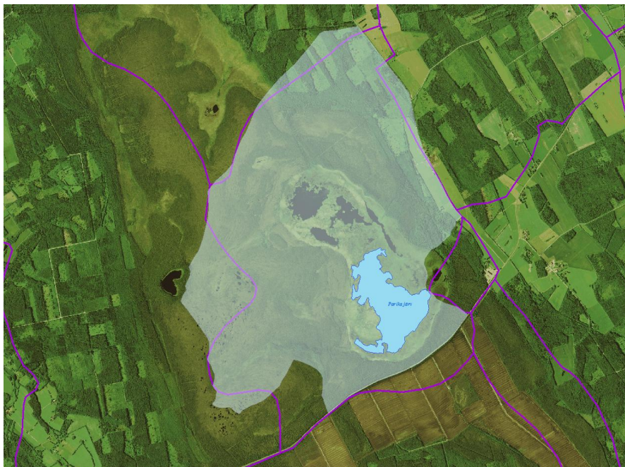
Joonis 14. Parika järve täpsustatud valgla (läbipaistev polügoon) ja Keskkonnateabe Keskuse andmebaasi veelahkme piirijooned (violettne joon).
