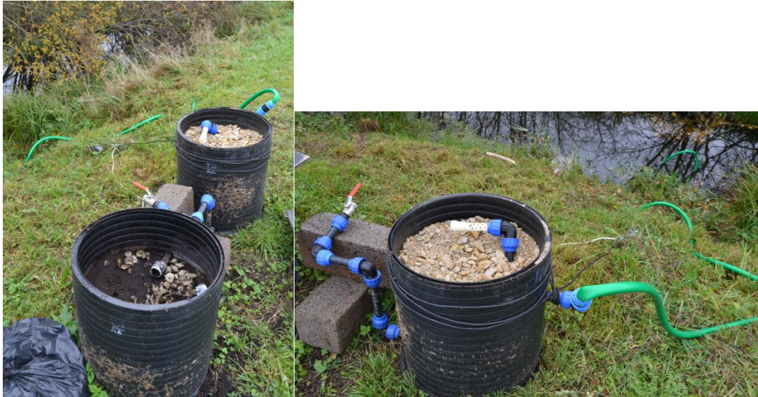
Joonis 2.9. Loodete tüüpi tehismärgala pilootuuring tuhaplatoo settega.
