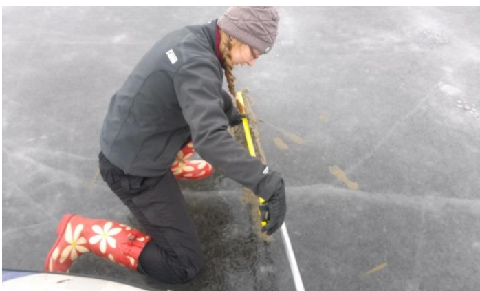
Joonis 4. Harku järvemuda paksuse määramine (Foto: A. Nõmmik)
