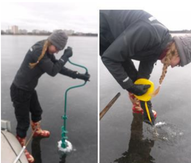
Joonis 3. Jääpuuriga jäässe ava tegemine ja veetaseme määramine (Foto: A. Nõmmik)
