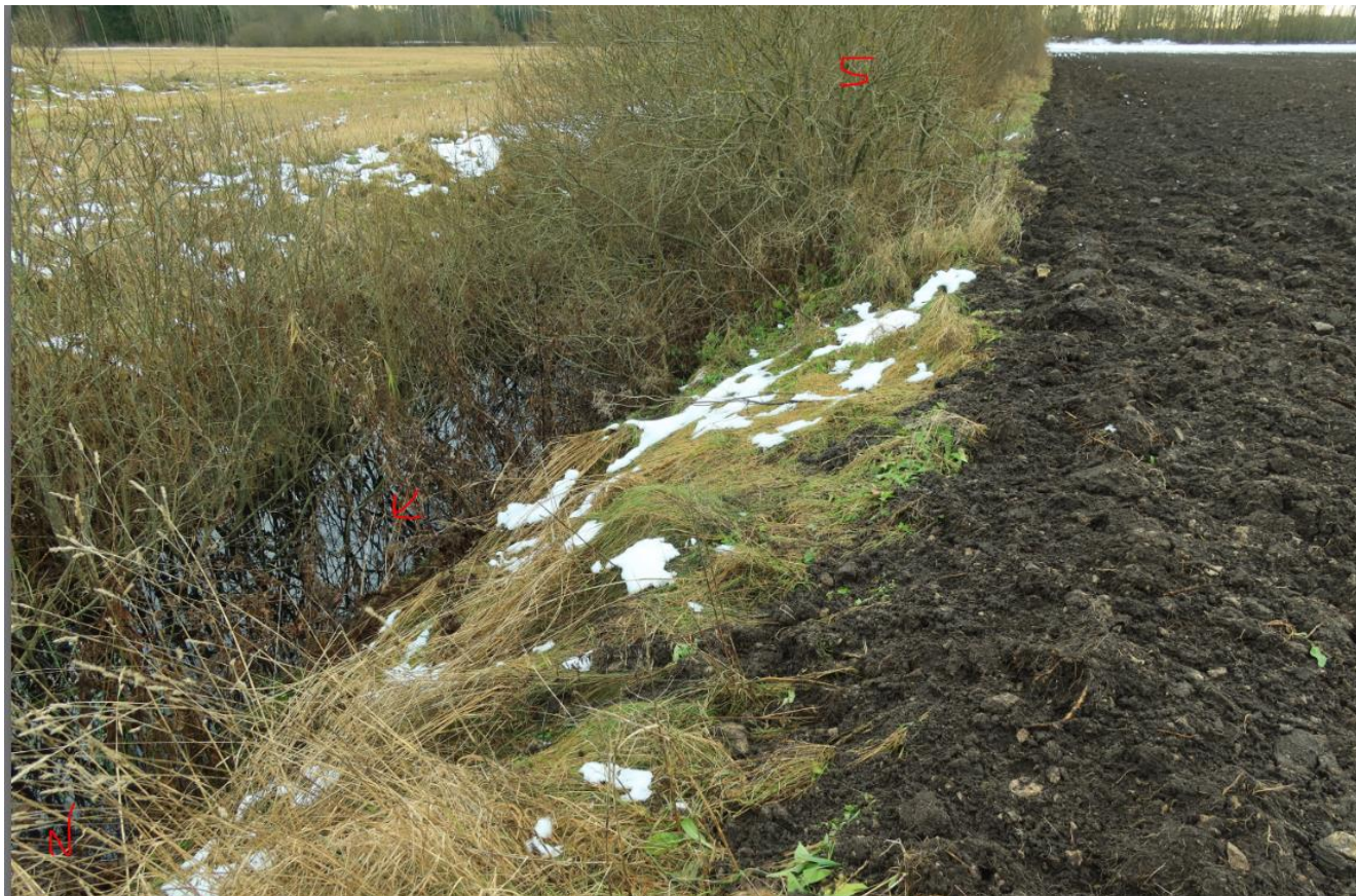
352. Kraavi vasakul kaldal, veepiirist meetri kaugusel ja veetasemest kümmekond cm kõrgemal oli 10 cm läbimõõduga avaus, millest voogas vett üles. Nägi välja nagu allikas, aga ilmselt ikkagi dreeniots, sest drenisuidmete kihil olev punkt oli siin lähedal. Q oli ca 0,2 l/s. SEC oli 677 \mu S/cm:
