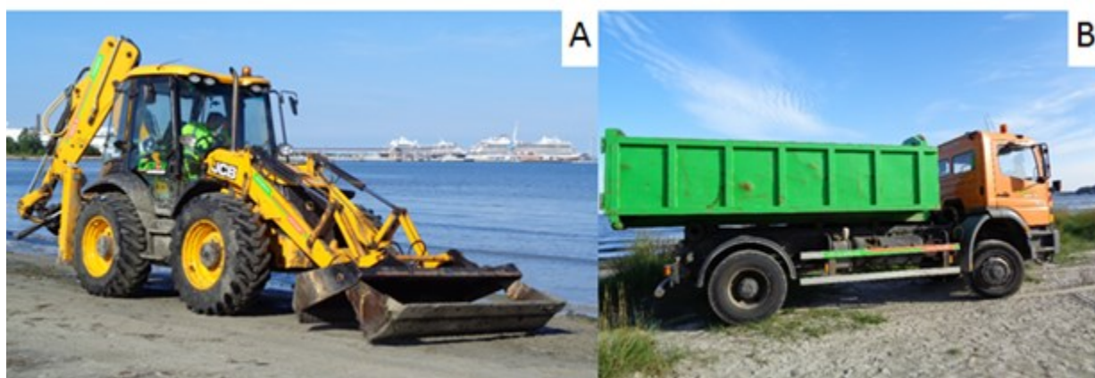
Joonis 4. Kopa ja sahaga varustatud traktor (A) ja 20 tonnine kallur (B).
