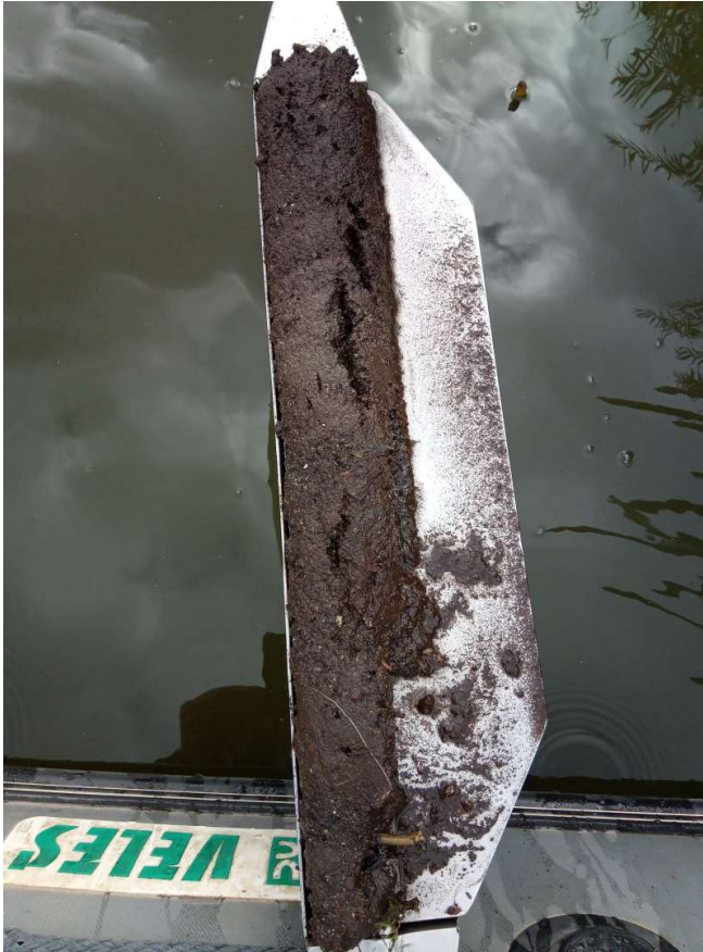
Foto 7.10.6. Väike-Anne kanali sete (Ingmar Ott 6.09.2022).
