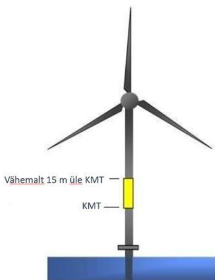
Joonis 35. Üksiku tuuleturbiini märgistamise näide 32
