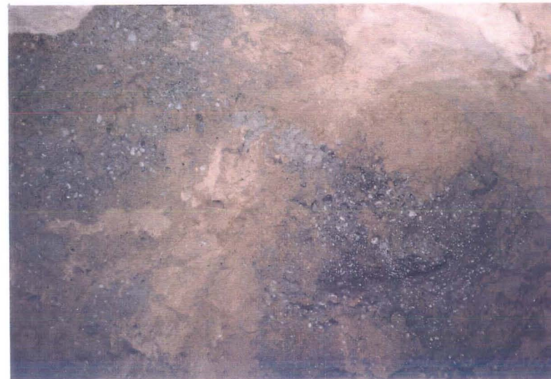
Foto 4. Masuudihoidla peapumpla juures olev kontrollauk 22.10. 1997. 1,5 m sügavuselt algab masuudiga reostunud kruusakiht. Antud kontrollauk rätis juba mõne tunni jooksul pinnase veega, mille peale moodustus eheda masuudi kiht.
