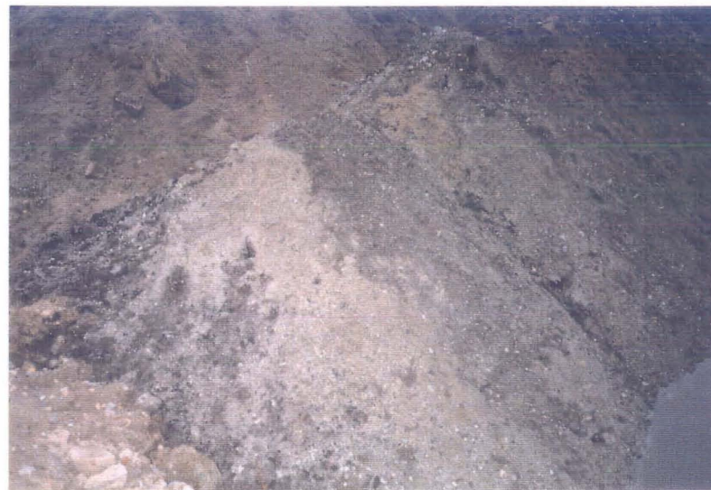
Foto 3. Maapinnast 1,5...3,0 m sügavusel olev kruusakiht on imunud läbi eheda masuudiga, mis kandus/kandub pinnase veega savi- liivakihipealse kruusakihi kaudu merre. Antud foto on tehtud 22. oktoobril 1997. a.
