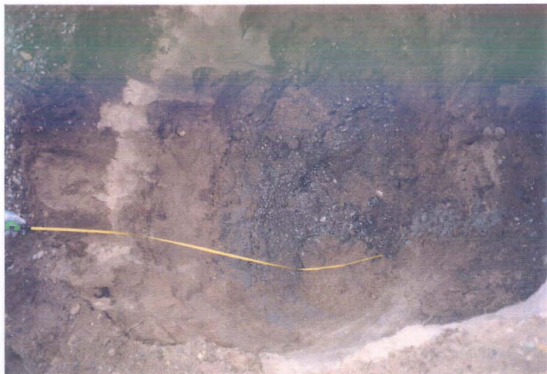
Foto 13. Avatud süvendis, endise kütusehoidla territooriumil, on näha peenliivakihi all masuudiga läbiimbunud kruusakiht. Süvendi sügavuseks on 2,5 m.
