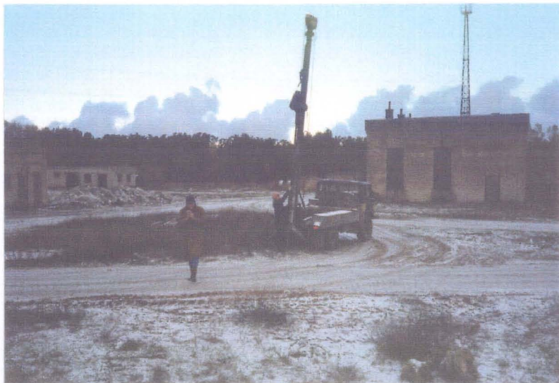
Foto 5. Kütusehoidla ja diiseljõujaama septiku kõrval oleva puuraugu P - 5 0,5 m paksuses kruusakihis on masuudi kontsentratsioon alla sihtarvu. Antud kohas oli pinnaseveetase maapinnast 24.10.97 1,3 m. 2,0 m sügavuselt algab saviliiv.
