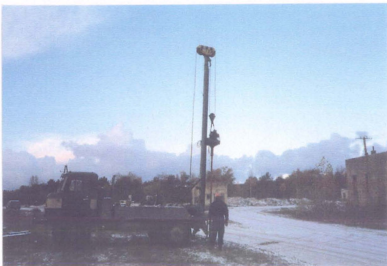
Foto 6. Puuraugu P - 6 2,5 m paksuses kruusakihis ületab masuudi kontsentratsioon 2,2 kordselt tööstustsooni sihtarvu. 2,0 m sügavusel algab saviliiv ja pinnasevesi (24.10.97).
