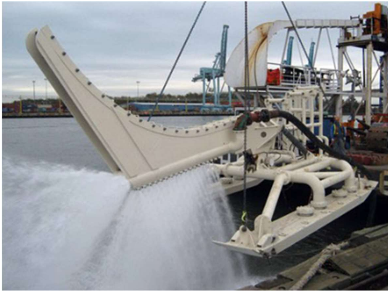
Foto 1. Kaablite paigaldamise seade „Mod Jet“ (laeva tõmmatav hüdroader). Allikas: https://eta-ltd.com/jetting-sleds-for-subsea-power-cable-laying/
