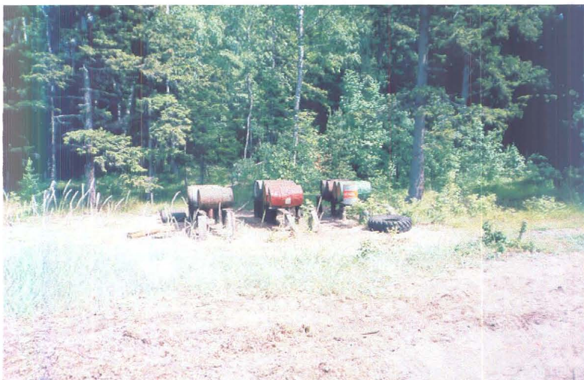
Foto 4. Natukene eraldi asub betoon- ja puitalusel olev õlihoidla 200 liitrise mahuga vaa- tidele. Fotograaf N. Reinap. Foto kuupäev 07.07.1998
