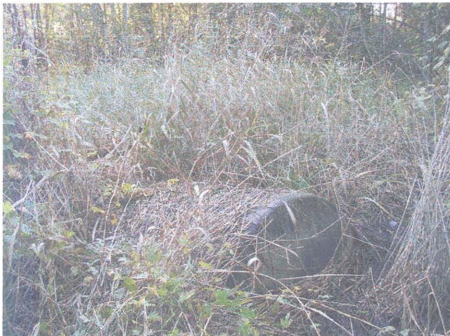
Foto 3. Kraavis avastatud mahuti, sisaldas naftasaaduste ja vee segu
