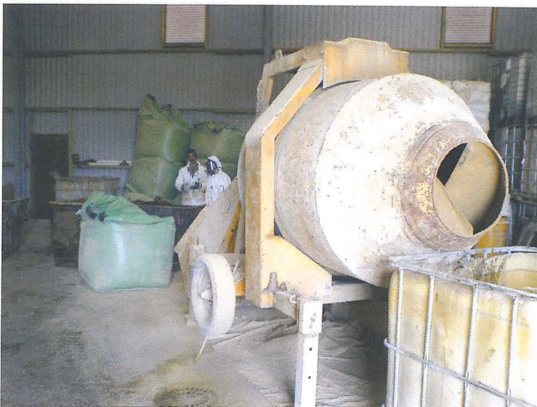
Töödeldud arseenijäätmete tahkestamine põlevkivituhaga ning laadimine matmismahutitesse
