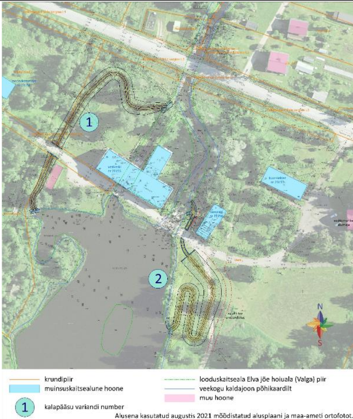
Joonis 11. Asendiplaan koos variantidega kalapääsu paigutamiseks vesikompleksi. Variante on lühidalt kirjeldatud järgnevas tekstis. Allikas: maa-ameti kaardirakendus.
