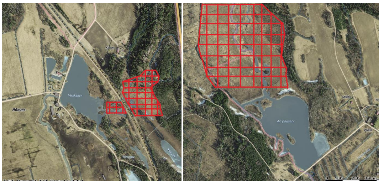
Joonis 4.3.3. Võimalikud alad (triibutatud punasega) settetiikide rajamiseks Nõmme Veskijärve (vasakul) ja Ao paisjärve (paremal) sissevooludel.
