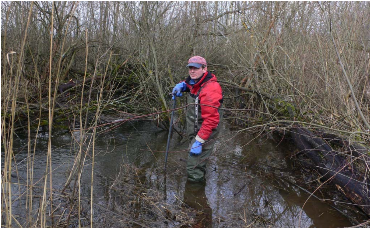
Foto 3. Oja põhjasetete uuring geoloogi käsipuuriga oja voolusängi keskel.
