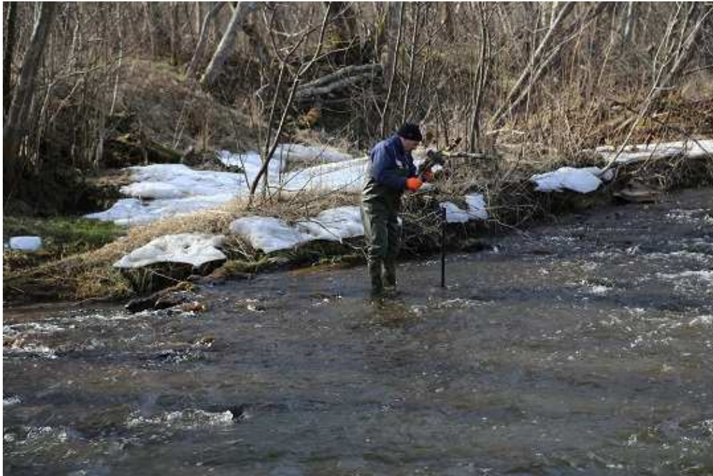
Foto 3. Esmane reostuseseire jõe parema kalda lähedal Koolme maaüksusel. Siit jõe põhjasetetest reostuse jälgi ei leitud (R. Järvekülg, 11.04.2014).
