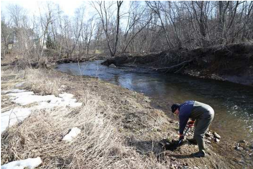
Foto 5. Reostunud jõe vasak kallas, suurveega üleujutatav lammiala. Kõik siit ümbrusest võetud setteproovid olid reostatud või reostusjälgedega (R. Järvekül, 11.04.2014).
