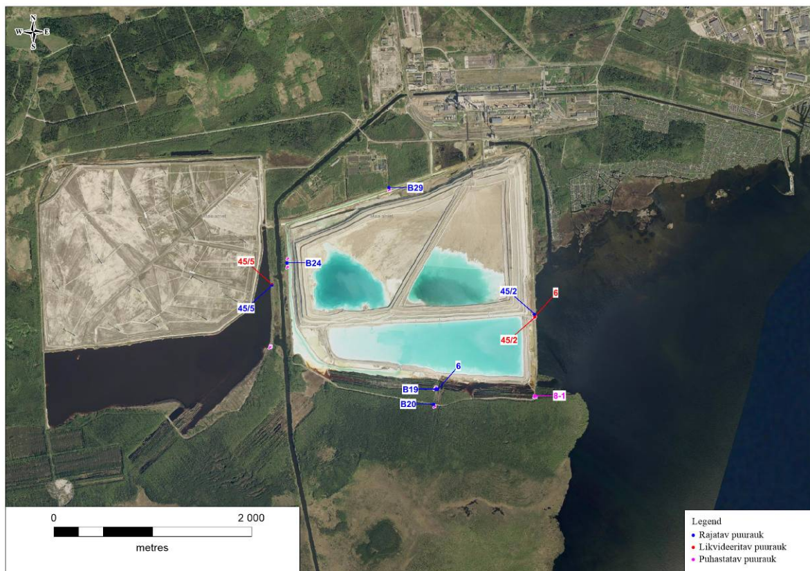
Joonis 4.1 Seirepuuraukud Balti elektrijaama tuhavälja ümbruses
