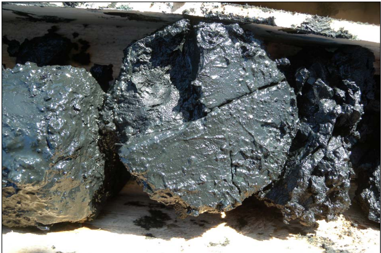
Foto 1. Väga peeneteraline poolkoks tasapinnalise sileda katkestuspinnaga.
