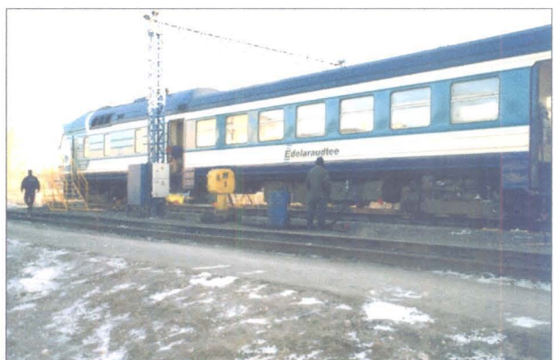
Foto 49. Tallinna depoo. Diislongide vaatluskanalid, kanalite vahel tankimisautomaat
