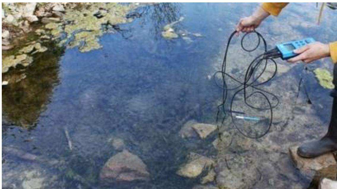
Joonis 18 Elektri juhtivuse ja pH mõõtmine
