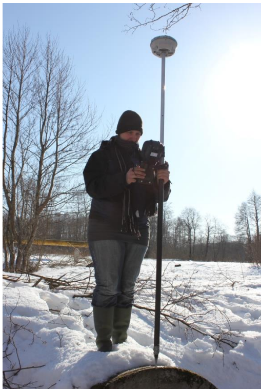
Joonis 16 Lävendite kõrguste mõõdistamine reaallaja gps-ga
