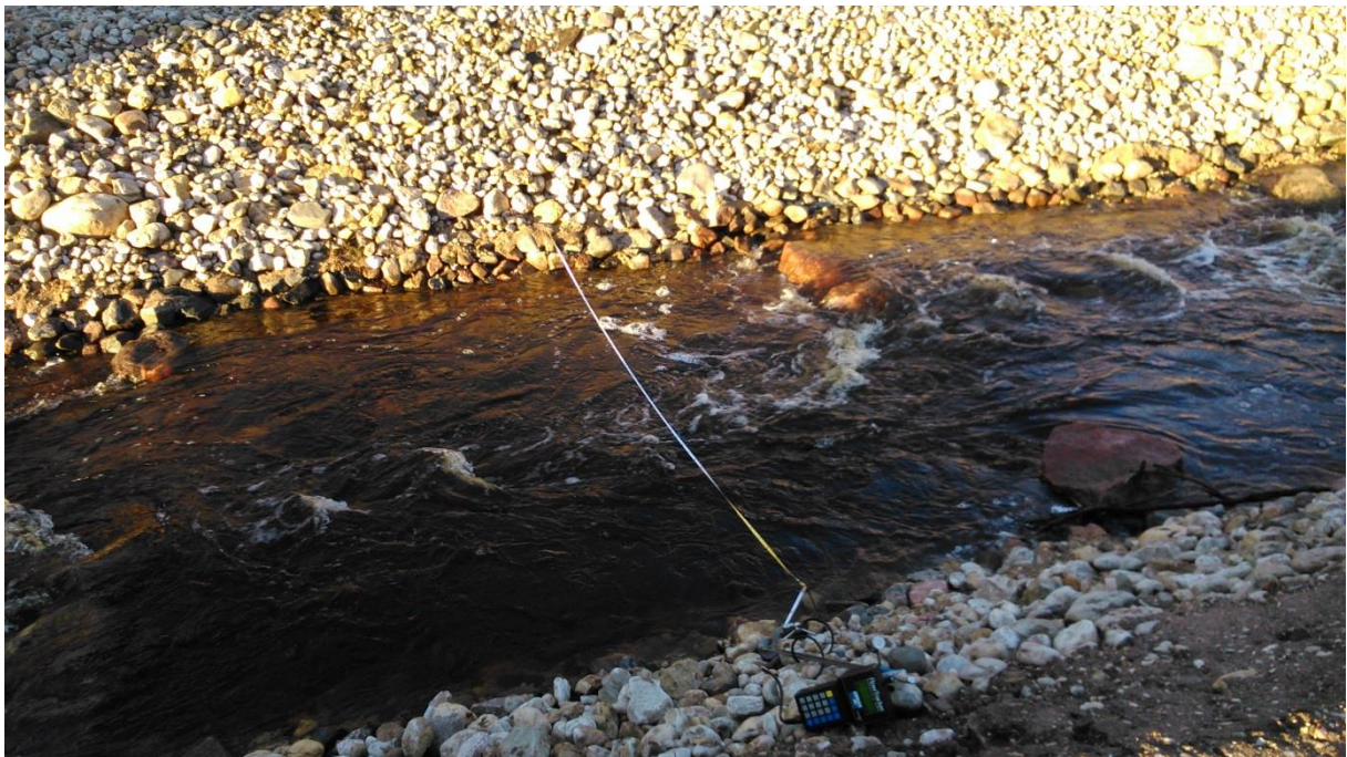
Foto nr 1. Kalapääsu vooluhulga mõõtekoht lävendil (foto: Argo Kuusik)
