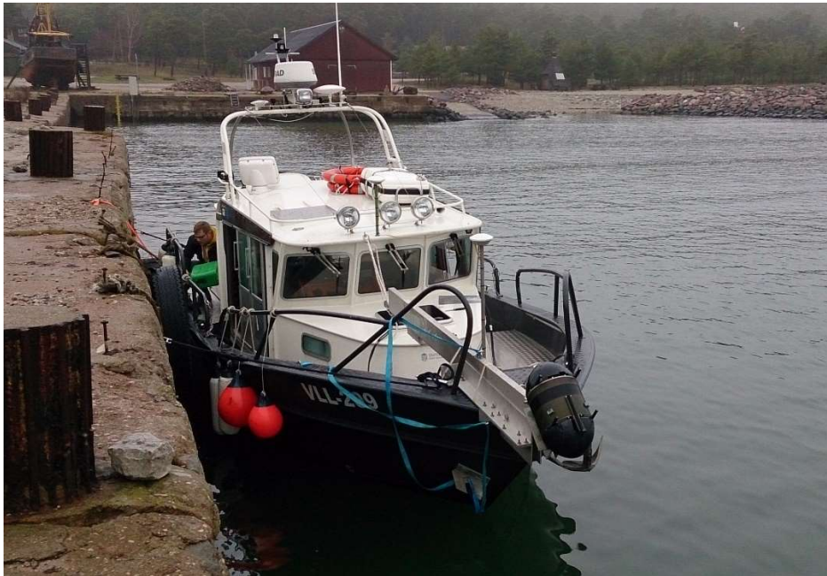
Joonis 2.3.2.1. TÜ Eesti Mereinstituudi uurimislav AluDevil 33. Vööris sonari Reson SeaBat 7101-Flow pea transpordiasendis.
