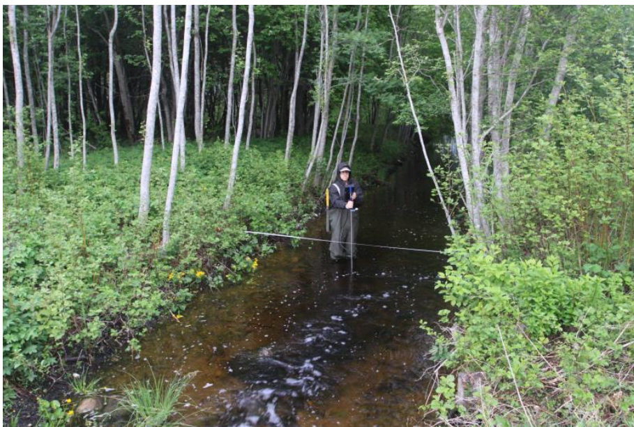
Foto 2.1.3.2. Töö voolumõõtjaga Flow Tracker Handheld ADV.
