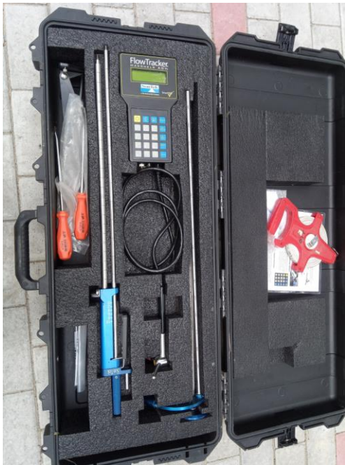
Foto 2.1.3.1. Vee voolumõõtja Flow Tracker Handheld ADV.
