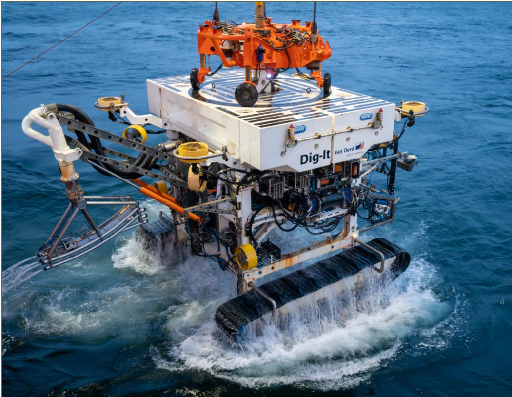
Foto 2.6-2. Kaablite paigaldamise seade „Trencher Deep DIG-IT“ (kaugjuhitav) 22
