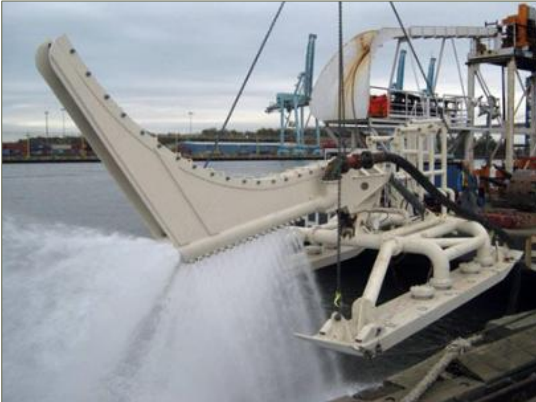
Foto 2.6-1. Kaablite paigaldamise seade „Mod Jet“ (laeva tõmmatav hüdroader) 21
