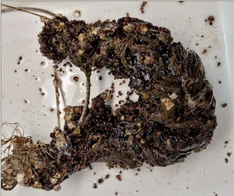
Joonis 3.4-15. Näidis eksperimentaal köiest peale 3 kuud vees olekut (TÜ EMI, 2024 – aruanne 3)
