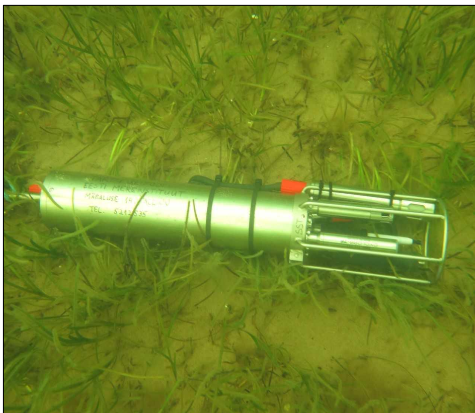
Joonis 2. Hapestumise parameetreid mõõdeti kasutades optilist CO 2 sensorit, mis oli ühendatud CTD sondisüsteemile.
