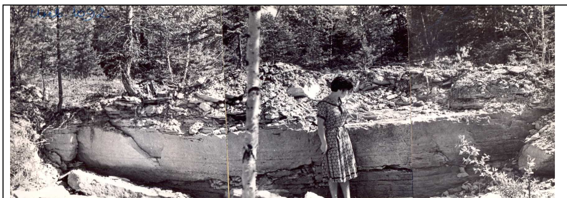
Foto 3. Orgita vana paemurru algus: 1958. aastal Märjamaa ümbruse viimistluskivi otsingutöö käigus rajatud katsekarjääri Orgita-I ja selle seinas paljanduvat massiivset kuni paksukihilise tekstuuriga dolokivi illustreeriv foto (Fritsman jt., 1958).
