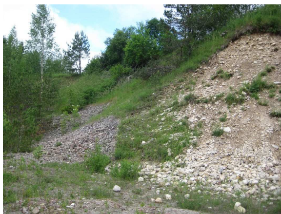
Foto 5 ja 6. Kaevandatud materjal: vanemas lõunanõlvas moodustab selle lubjakiviklibu, põhjanõlvas on kaevandatud aluspõhja-astangut lõunast piiravat ja katvat rähkset saviliivmoreeni.
