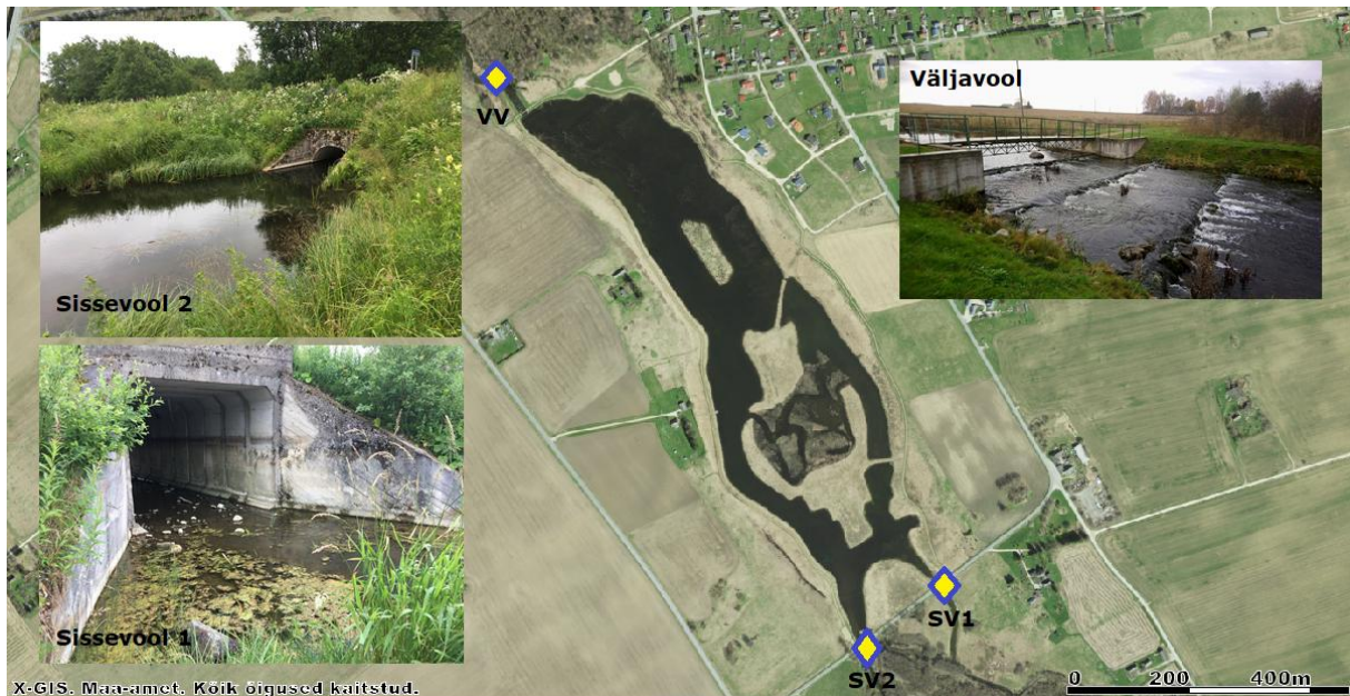
1.9.1.1. Vee vooluhulkade ja veeproovide proovivõtukohtad väliskoormuse hindamiseks Kadrina paisjärves (Maa-ameti kaardirakendus, 2018; autorite fotod).
