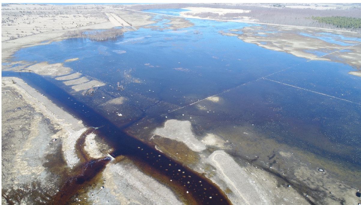
Foto 3.6.7. Kevadine üleujutus Teorehe rannaniidul. Piisava pealevoolu korral hoiab rajatud pinnasvall koos kalapääsu ja regulaatoriga vett rannaniidul suurel alal üleval, mis võimaldab haugil kueda ning marjal ja koorunud vastsetel areneda. (Foto: Roland Svirgsden 12.04.22)
