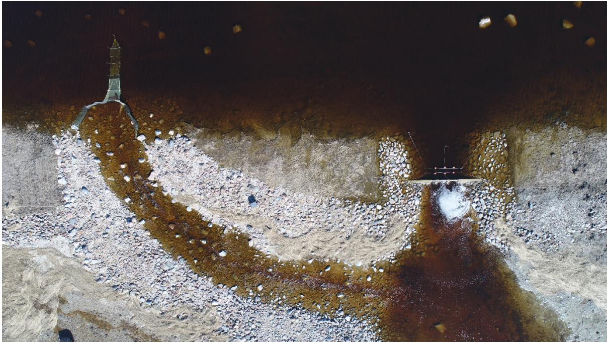
Foto 3.6.4. Koelmule tõusvate kalade tabamiseks paigaldati kalapääsu ülemise suudme ette spetsiaalne luhamõrd koos lühikeste traataiast tiibadega. Mõrra suust vahetult paremal on näha ka kudenud kaladele merre tagasipöördumise võimaldamiseks paigutatud lahtise päraga maimurüsa. Foto paremas osas on näha regulaatori ette paigaldatud PIT märgiseid registreeriv antenn. Teine analoogne antenn on paigaldatud kalapääsu põhja (fotol raskesti märgatav). (Foto: Roland Svirgsden 18.04.22)
