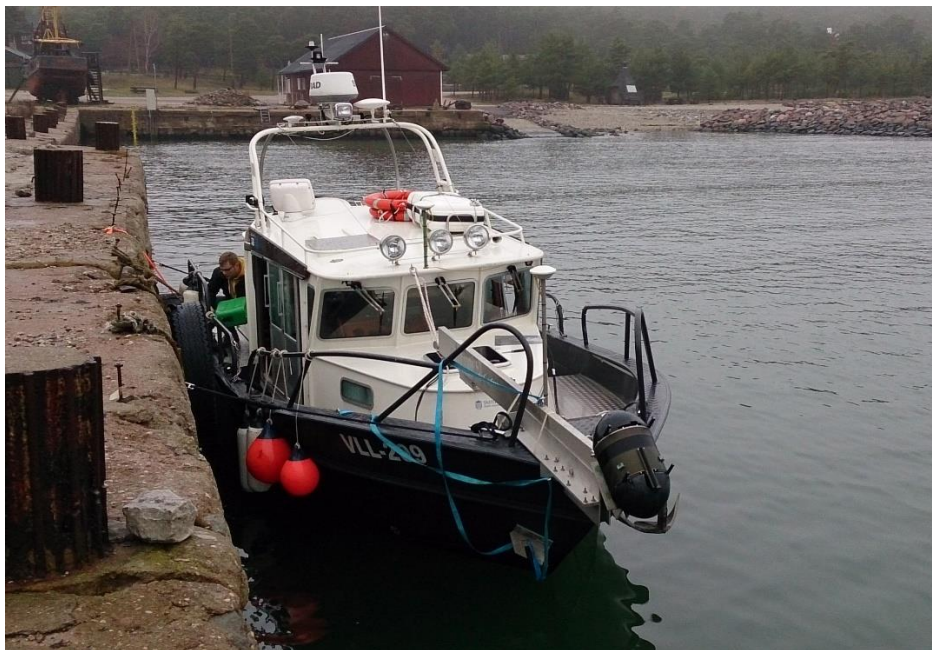
Joonis 2.3.1. TÜ Eesti mereinstituudi uurimislaev AluDevil 33. Vööris sonari Reson SeaBat 7101-Flow pea transpordiasendis.
