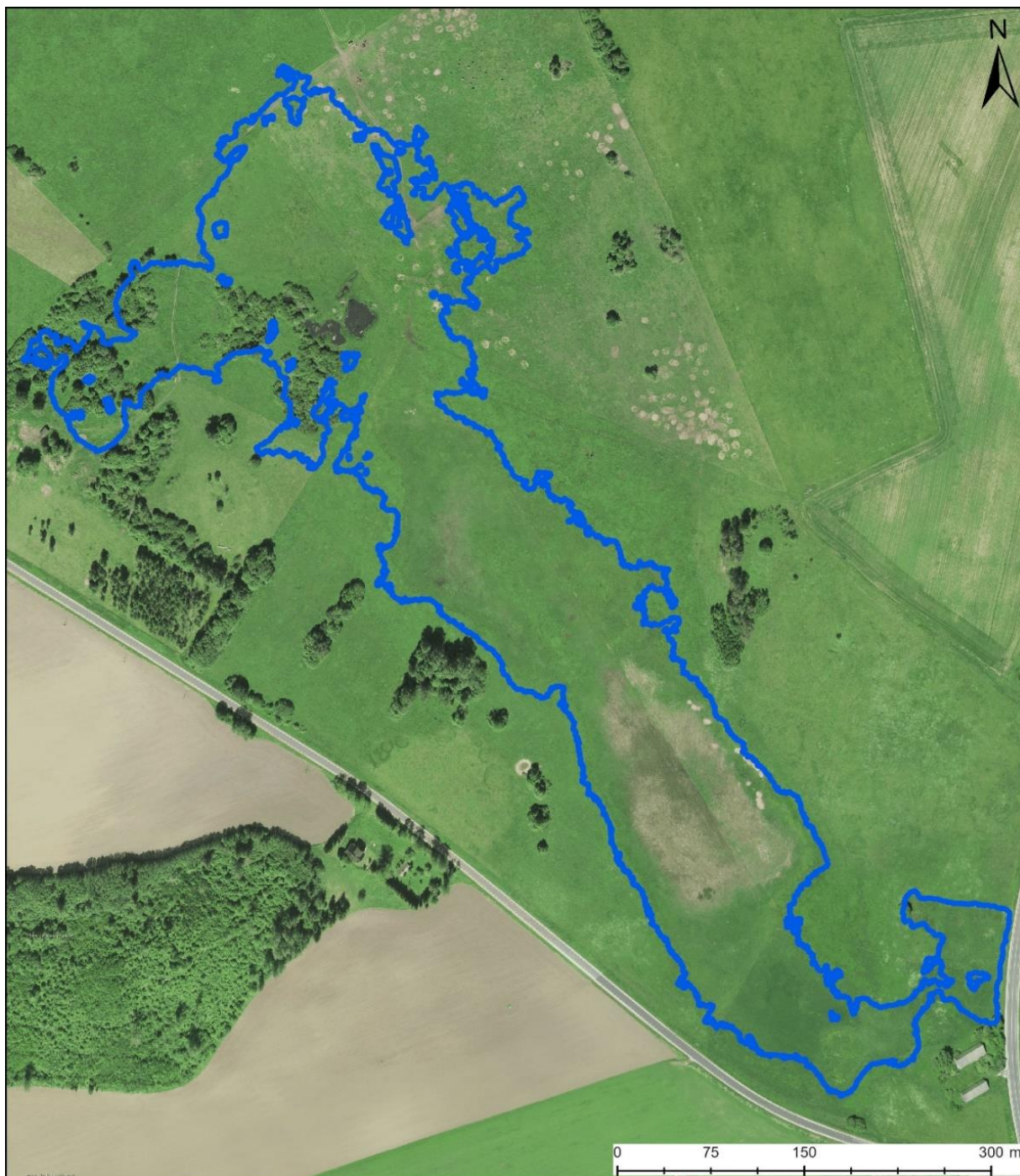
Joonis 4.2.5. Assamalla karstijärviku veepiir tasemel 113,3 m ü.m.p vastavalt Maa- ja Ruumiameti 2020. aasta metsandusliku lennu käigus kogutud LiDAR-andmete alusel loodud 1x1 m kõrgusmodelile.
