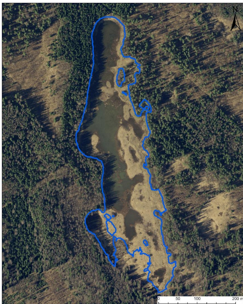
Joonis 4.10.6 Võhmetu karstijärviku veepiir tasemel 110,3 m ü.m.p vastavalt Maa- ja Ruumiameti 2013. aasta kevadise lennu käigus kogutud LiDAR-andmete alusel loodud 1x1 m kõrgusmodelile.
