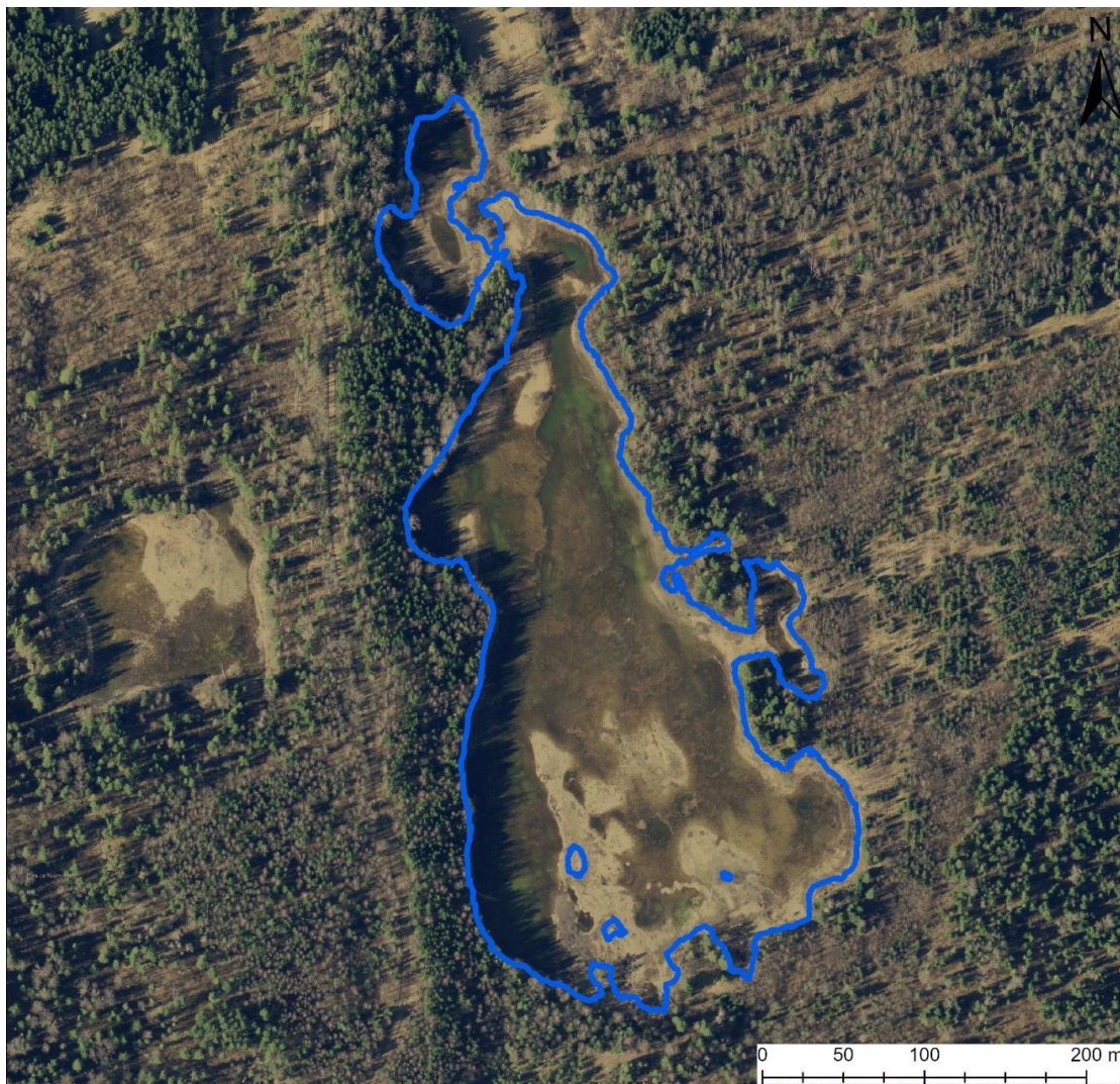
Joonis 4.7.6 Lemmküla karstijärviku veepiir tasemel 110,3 m ü.m.p vastavalt Maa- ja Ruumiameti 2013. aasta kevadise lennu käigus kogutud LiDAR-andmete alusel loodud 1x1 m kõrgusmodelile.
