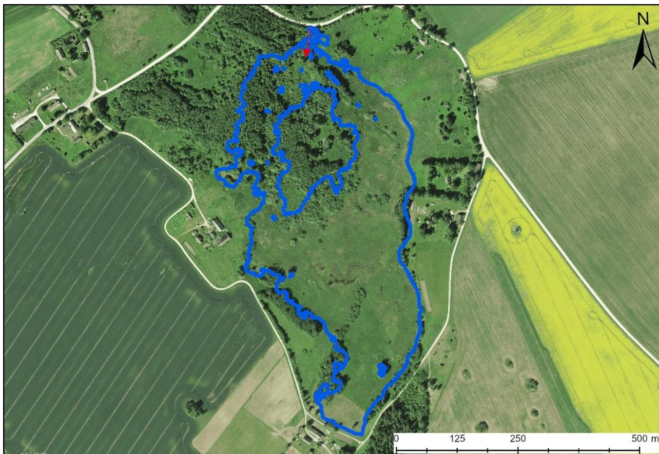
Joonis 4.4.5. Jalgsema karstijärvi veepiir tasemel 99,4 m ü.m.p vastavalt Maa- ja Ruumiameti 2020. aasta metsandusliku lennu käigus kogutud LiDAR-andmete alusel loodud 1x1 m kõrgusmodelile. Punase noolega on tähistatud pinnavee sissevoolu suund järvikusse.
