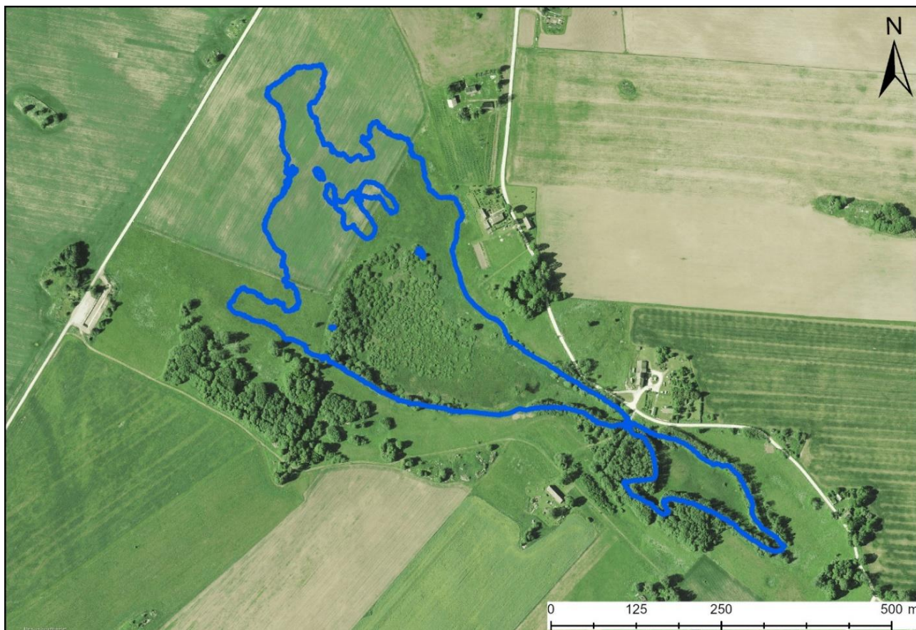
Joonis 4.9.5. Tudre karstijärviku veepiir tasemel 85,7 m ü.m.p vastavalt Maa- ja Ruumiameti 2020. aasta metsandusliku lennu käigus kogutud LiDAR-andmete alusel loodud 1x1 m kõrgusmudelile.
