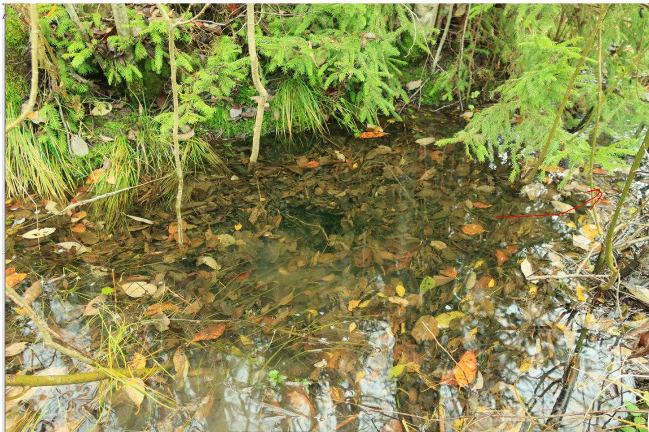
20. Tõusuallikas. Kraavi põhjas poolemeetrise läbimõõduga auk. Selle sees olid peenikesed oksad ning vesi voolas silmnähtavalt välja. Kraavi põhjas olid lehed. Vooluhulk oli mitu l/s. Allikast ülesvoolu oli kraavi põhjas seisev vesi. SEC 703 \mu\text{S}/\text{cm} , temp 8,9°C, pH 7,4:
